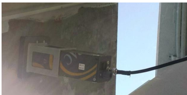
Slika 6.6 Pozicioniranje EM senzora na metalno kućište mjernog transformatora - CGES
