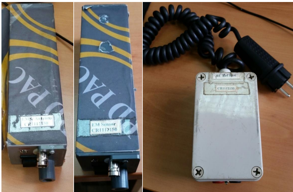
Slika 6.2. Glavne komponente PD-PAC uređaja: Antena senzor, EM senzor i AC reference synchronous Box respektivno
