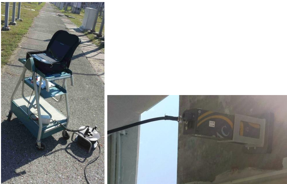
Slika 7.1 Postavka opreme i pozicioniranje EM senzora - CGES
