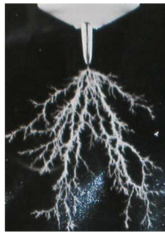
Slika 2.6c Električno pražnjenje u čvrstoj izolaciji - tzv. 'treeing'
