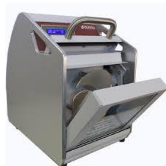
Slika 78. Stomaher za homogenizaciju uzoraka www.boekelsci.com
