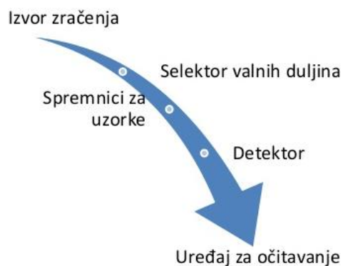
Slika 92. Princip metode atomske apsorpcione spektrometrije https://sr.wikipedia.org/
