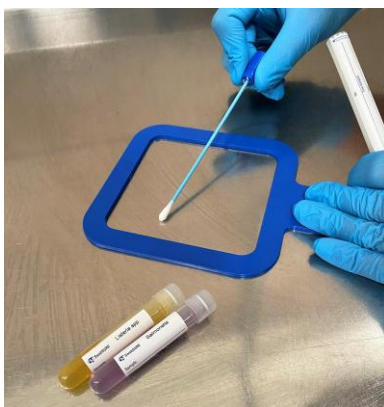
Slika 72. Uzimanje brisa sa radne površine https://800ezmicro.com/supplies/surface-swabbing
