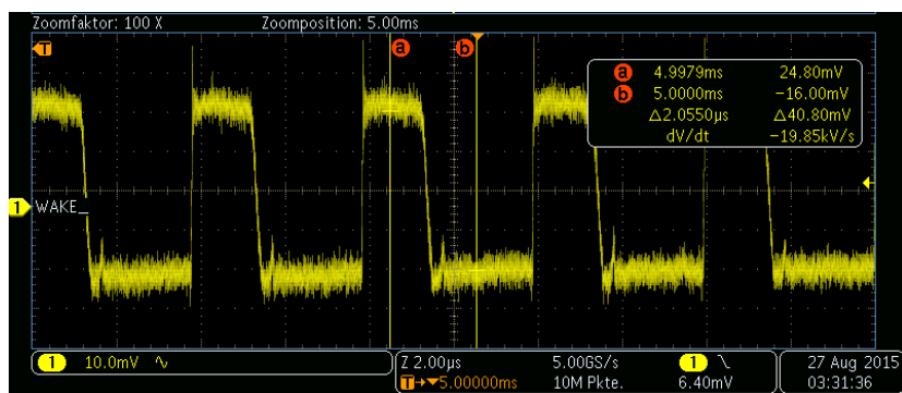
Slika 5.8: Oscilacije izlaznog napona.
