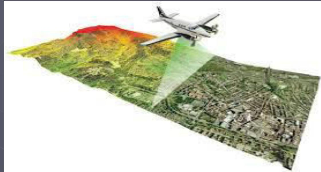
Udaljenost od senzora do mjerene tačke određuje na osnovu mjerena vremena koje je potrebno da laserski impuls stigne do objekta i reflektuje se nazad.
