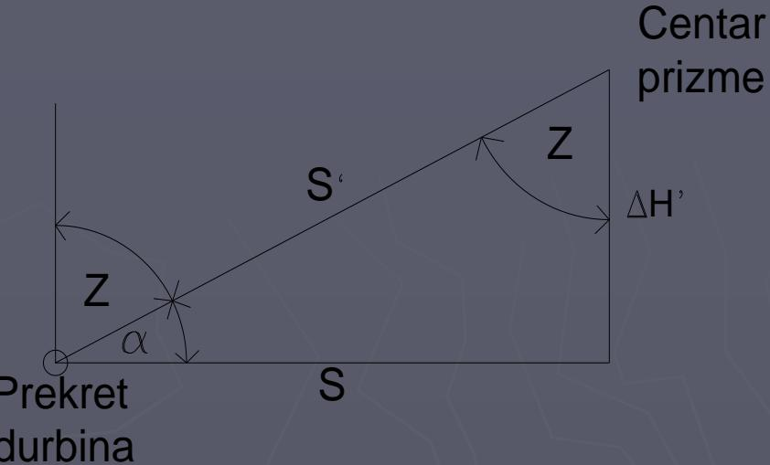
3. Slučaj – mjerena horizontalna dužina  $S$  i vertikalni ugao  $\alpha$ .
