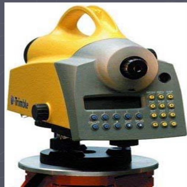
Poslije dovođenja mjehura centrične libele da vrhuni instrument je doveden u područje kompenzacije.
