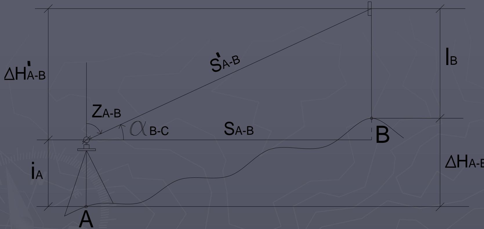
Vrijednosti izmјerenog vertikalnog ugla (ili zenitnog odstojanja) i kose (ili horizontalne) dužine se kod totalnih stanica vide direktno na displeju.
