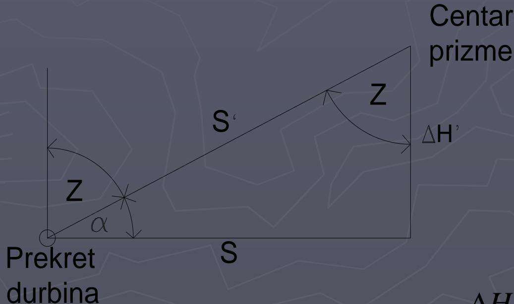
1. Slučaj – mjerena kosa dužina  $S'$  i vertikalni ugao  $\alpha$ .  $\sin \alpha = \frac{\Delta H'}{S'} \quad \Delta H' = \sin \alpha * S'$
