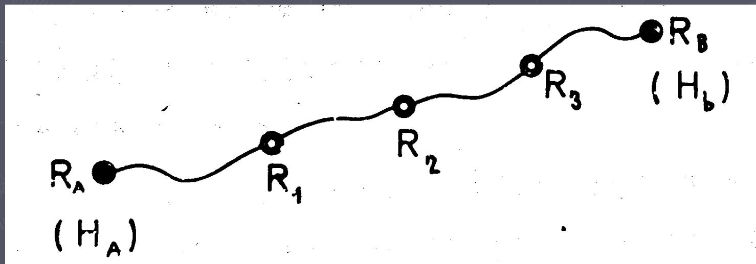
Vlak koji se samo jednim krajem oslanja na dati reper je slijepi nivelmanski vlak.
