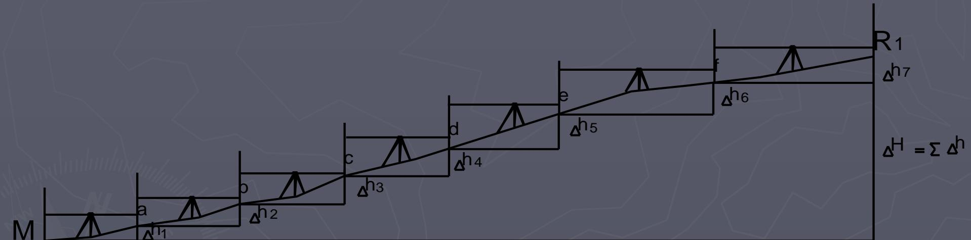
Kad se završi mjerenje sa jedne stанице, niveler se premješta na novu stanicu a letva koja je bila na tački „a“ ostaje na svom mjestu i samo se okrene oko vertikalne ose za  $180^\circ$  dok se letva sa tačke M prenosi na sljedeću tačku „b“.
