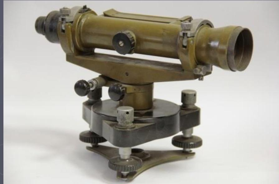
Ako je poduzna osa durbina horizontalna, tada će i vizura biti horizontalna, pa će se dobiti ispravno čitanje podjele letve.
