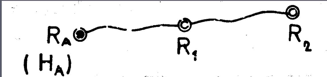
Ako nivelmanski vlak počinje i završava se na istom reperu onda se on naziva zatvoreni nivelmanski vlak ili nivelmanski poligon.
