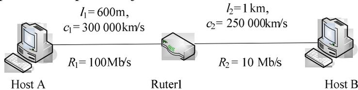
3. Na slici je prikazan način povezivanja dva hosta, posredstvom dva *store and forward* komutatora. Prenosi se fajl veličine  $F=300\text{kB}$ . Zanimljivo su komponente kašnjenja uslijed obrade u komutatorima i u redu čekanja. Za podatke kao na slici, izračunati:
