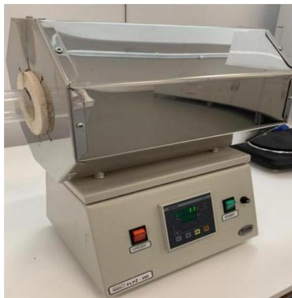
*Slika 14. Peć za žarenje (model Vims FLPŽ-300)*
