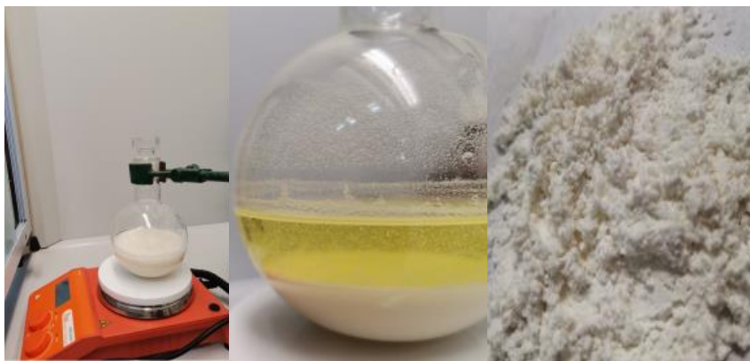
Slika 24. Sinteza liganda (\text{NH}_4)_3\text{idadc}
