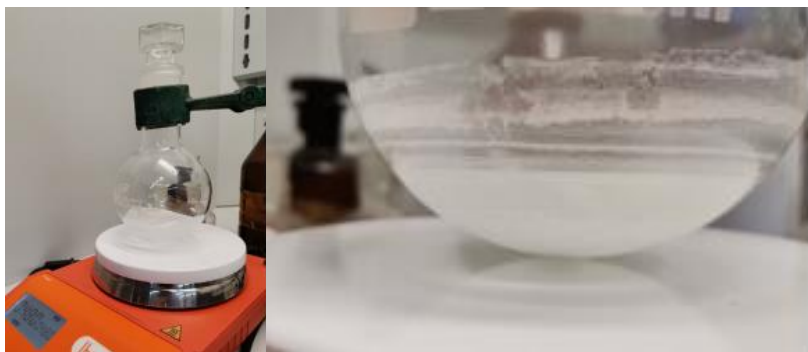
Slika 25. Sinteza kompleksa \text{NH}_4[\text{Zn}(\text{idadtc})(\text{en})]
