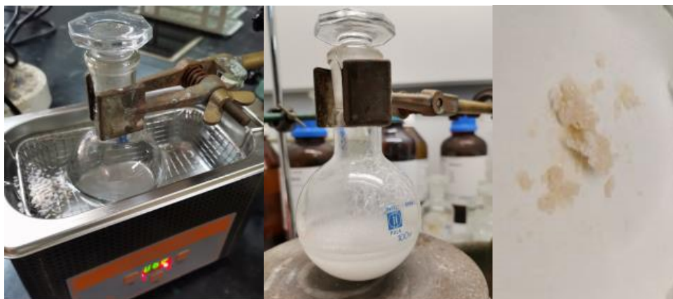
Slika 26. Sinteza kompleksa \text{NH}_4[\text{Zn}(\text{idadtc})(\text{en})_2]
