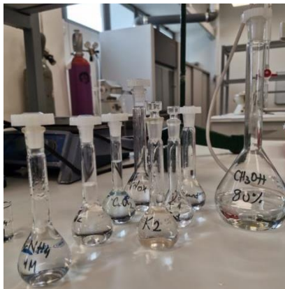
Slika 38. Pripremljeni rastvori za antioksidativna ispitivanja liganda (\text{NH}_4)_3\text{idadt} i kompleksa \text{NH}_4[\text{Zn}(\text{idadt})(\text{en})] i \text{NH}_4[\text{Zn}(\text{idadt})(\text{en})_2]
