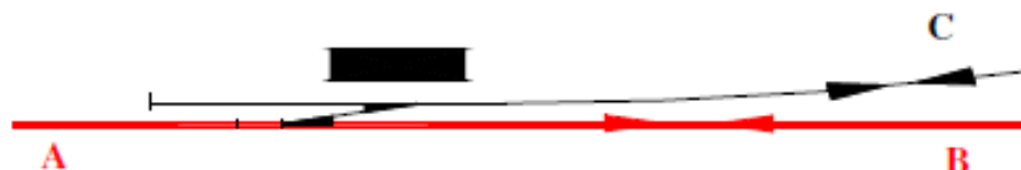
Slika III-1. Šematski prikaz rasputnice na jednokolosečnoj pruzi AB u kojoj se priključuje jedna jednokolosečna pruga iz pravca C
