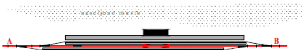
Slika III-3. Šematski prikaz ukrsnice sa dva obostrano vezana koloseka za ukrštanje, odnosno preticanje vozova, koja obavlja i saobraćaj lokalnih putnika
