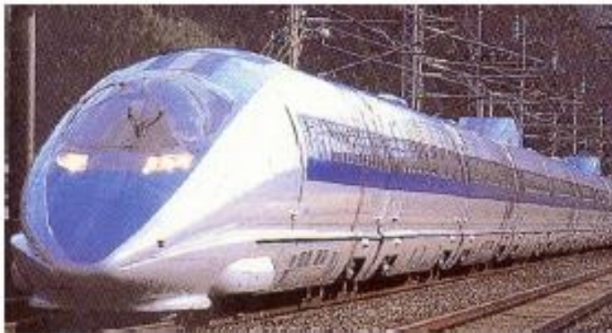
Slika V-4. Levo: Aerodinamički oblikovano čelo voza na prugama u Japanu; Desno: Čelo voza za velike brzine na prugama Francuske, Belgije i Holandije (SNCF-Thalys)
