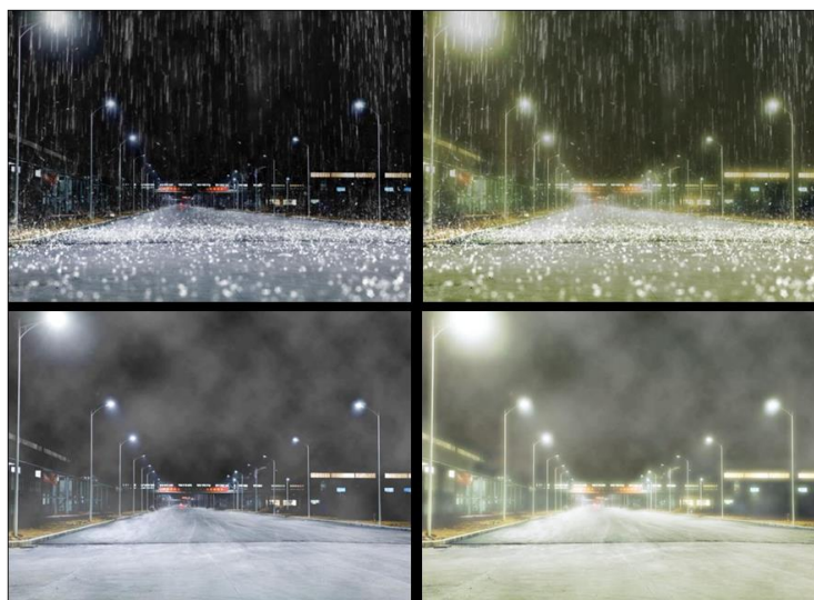
Slika 3. Poređenje LED-a (levo) i HPSV-a (desno) pod uslovima kiše i magle: Bela svetlost LED-a proizvodi manje odsjaja nego žuto svetlo HPSV-a u uslovima kiše i magle
