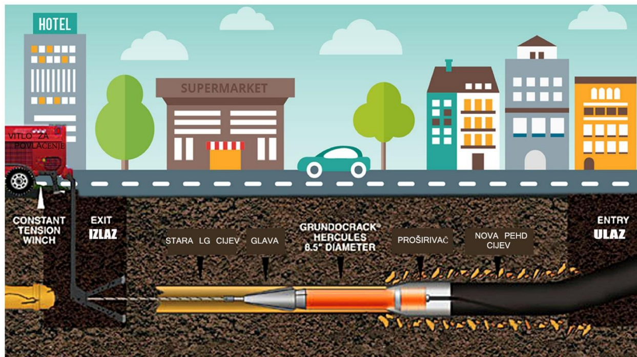
slika 6.11. Komponente sistema pipe bursting ( www.atozinfra.com )
