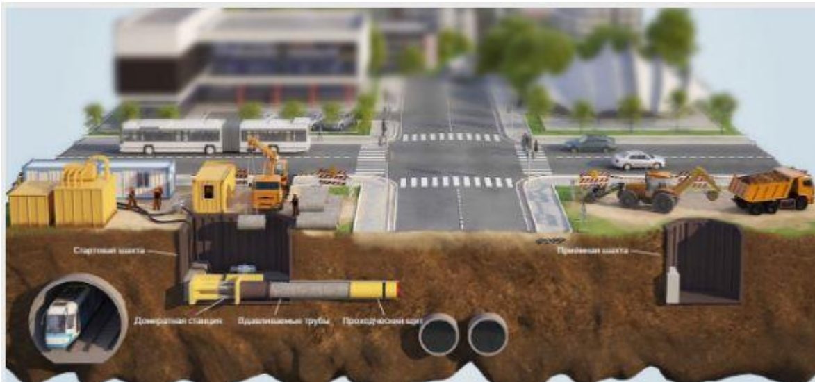
Slika 6.6. Animirani prikaz prolaska kolektora ispod saobraćajnice ( www.asiatimegroup.com )
