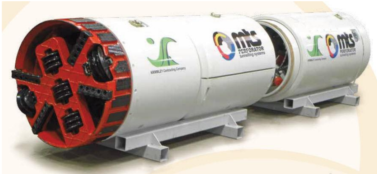
Slika 7.5. Mašine kompanije Mts perforator za metod mikrotuneliranja koje su korišćene na projektima u Poljskoj i Australiji ( www.mts-p.de )
