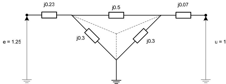
Treba primjetiti da, pošto je kvar 3KS na sredini voda, impedansa voda se dijeli na dva jednakna dijela. Takođe, uočava se trougao impedansi koji je potrebno transfigurisati u zvijezdu kako bi se odredila tražena impedansa  $Z_{gmr}$  u ovom režimu.
