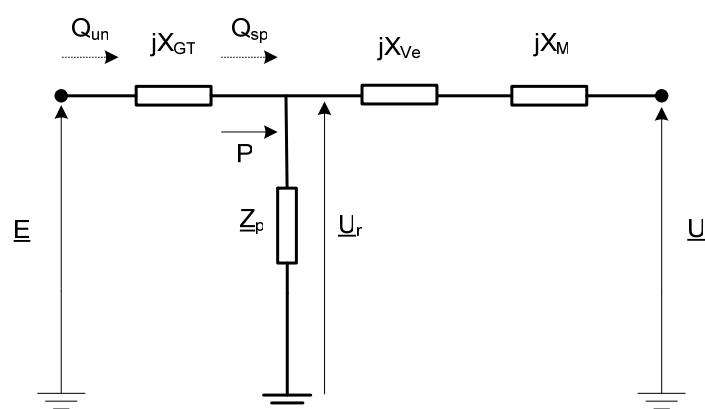
Kako je potrebno pronaći opseg statički stabilnog rada s aspekta reaktivne snage, potrebno je provjeriti kriterijum statičke stabilnosti prema jednačini,
