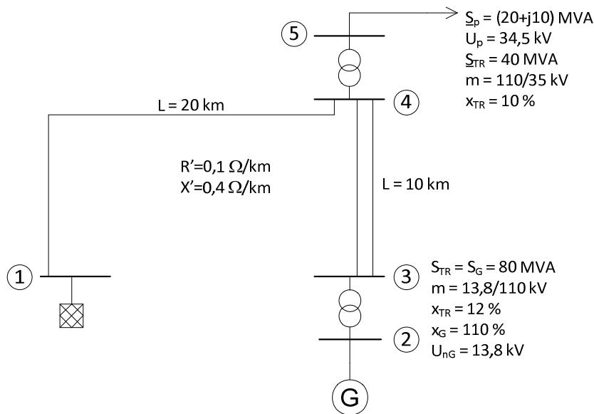
Za dati trofazni, jednopolno prikazani sistem provjeriti da li će sistem ostati stabilan ukoliko dođe do povećanja potražnje na sabirnicama bloka GTR za 60%. Generatorske jedinice su prije poremećaja potražnje ravnomjerno opterećene snagom  $P=150$  MW uz faktor snage 1.
