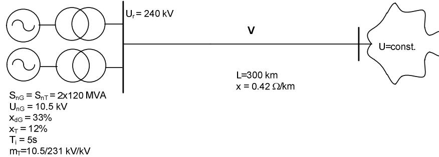
Za dati trofazni jednopolno prikazani EES odrediti opseg reaktivne snage  $Q$  u okviru koga može da radi statički stabilno generator koji na sabirnice 1 odaje ukupnu snagu  $P = 700$  MW, ako se jaka mreža na kraju može zamjeniti reaktansom izračunatom iz udjela te mreže u trajnoj snazi tropolnog kratkog spoja na sabirnicama 2 i konstantnim naponom iza te reaktanse.
