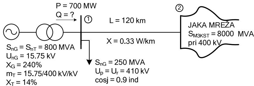
Za dati trofazni, jednopolno prikazani sistem provjeriti kolika i kakva reaktivna snaga se može isporučiti potrošaču a da generator priključen na sabirnice A radi statički stabilno. Generator priključen na sabirnice D radi sa konstantnim nominalnim naponom i snagom prikazanom na slici. Kod oba generatora se faktor snage kreće u opsegu od 0.8ind do 0.8cap.
