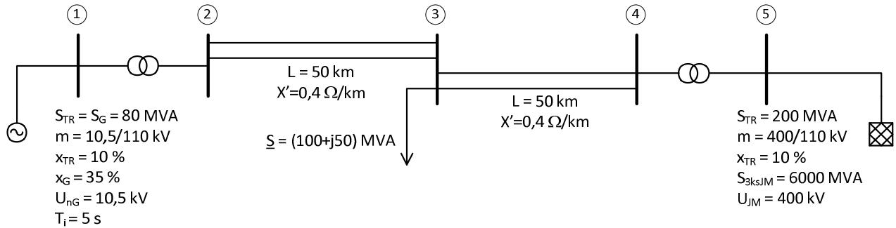
Za sistem dat na slici odrediti kolika se maksimalna aktivna snaga može isporučiti preko vodova od čvora 3 ka čvoru 4 pri konstantnom faktoru snage od 0,9 i nominalnom naponu na sabirnicama 4. Zanemariti aktivnu komponentu ulazne impedanse na mjestu generatora. Jaku mrežu u čvoru 1 modelovati kao mrežu beskonačne snage.
