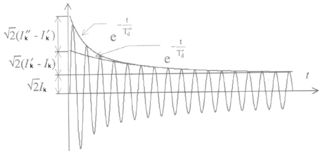
*Naizmjenična komponenta struje troplnog kratkog spoja*
