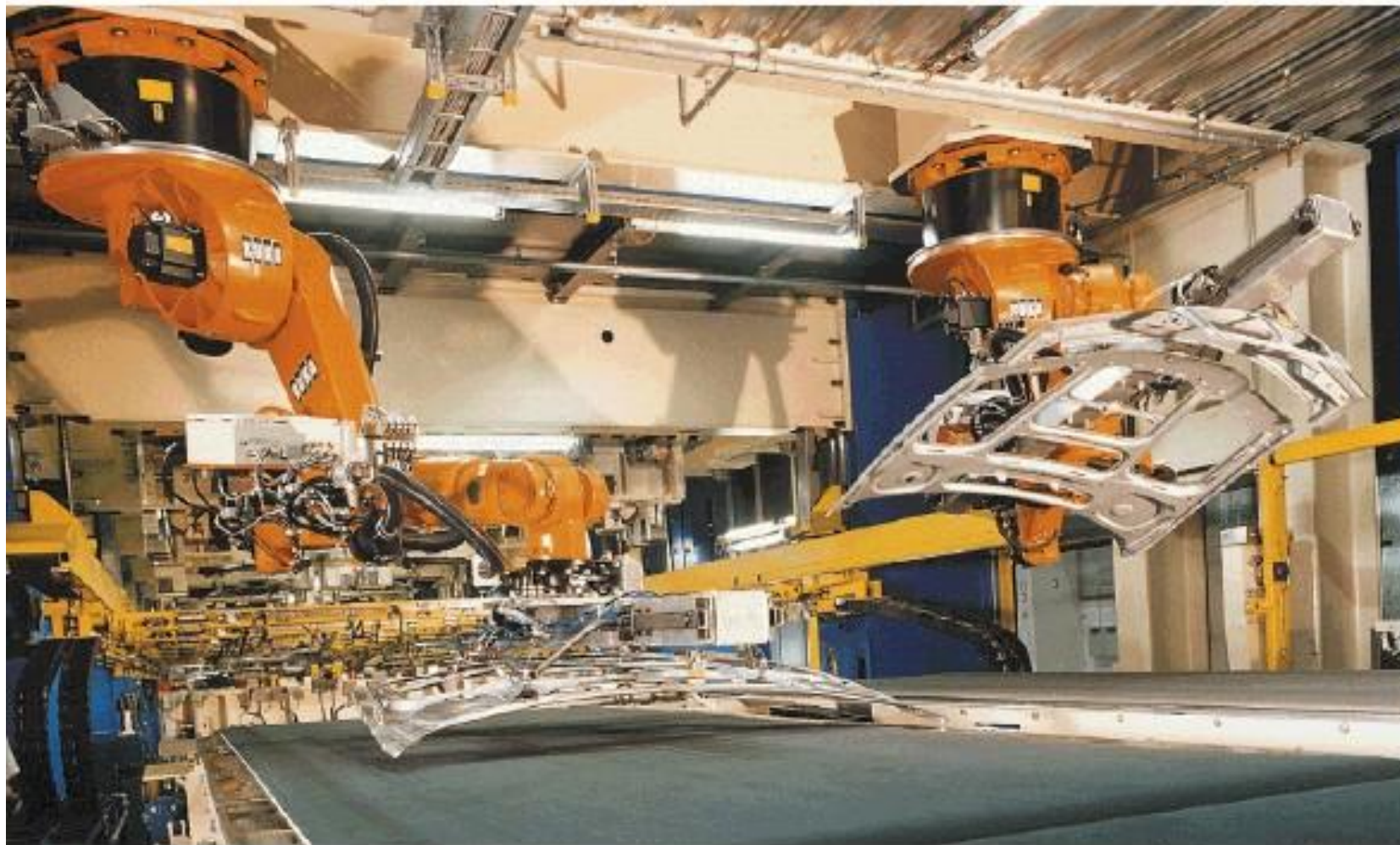
Slika 30: Primjena robota pri premještanju haube automobila
