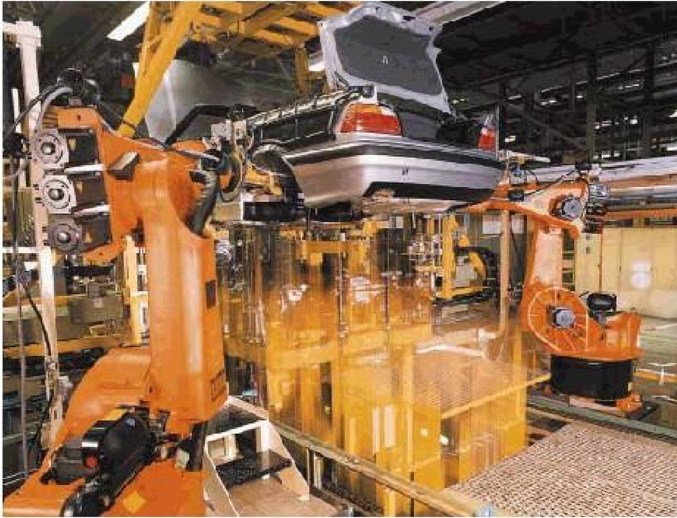
Slika 34: Primjena robota pri postavljanju automobilskih osovina
