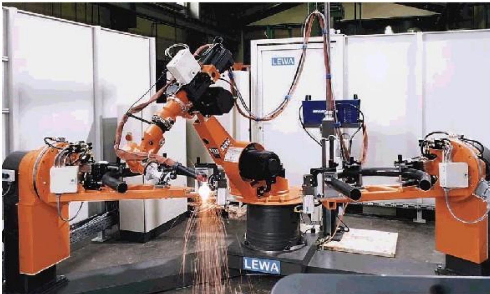
Slika 14: Primjena robota pri rezanju plazmom
