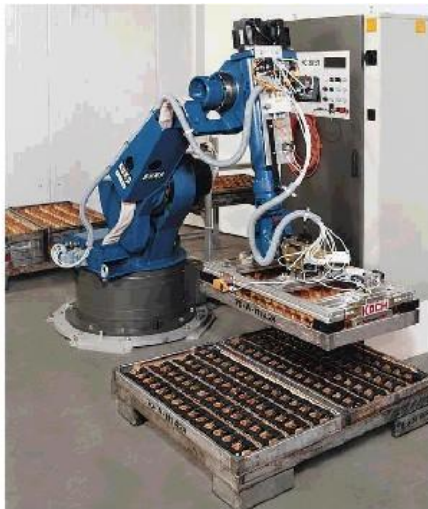
Slika 24: Primjena robota pri pakovanju
