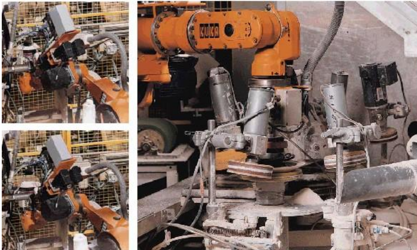
Slika 11: Primjena robota pri obradi porculana
