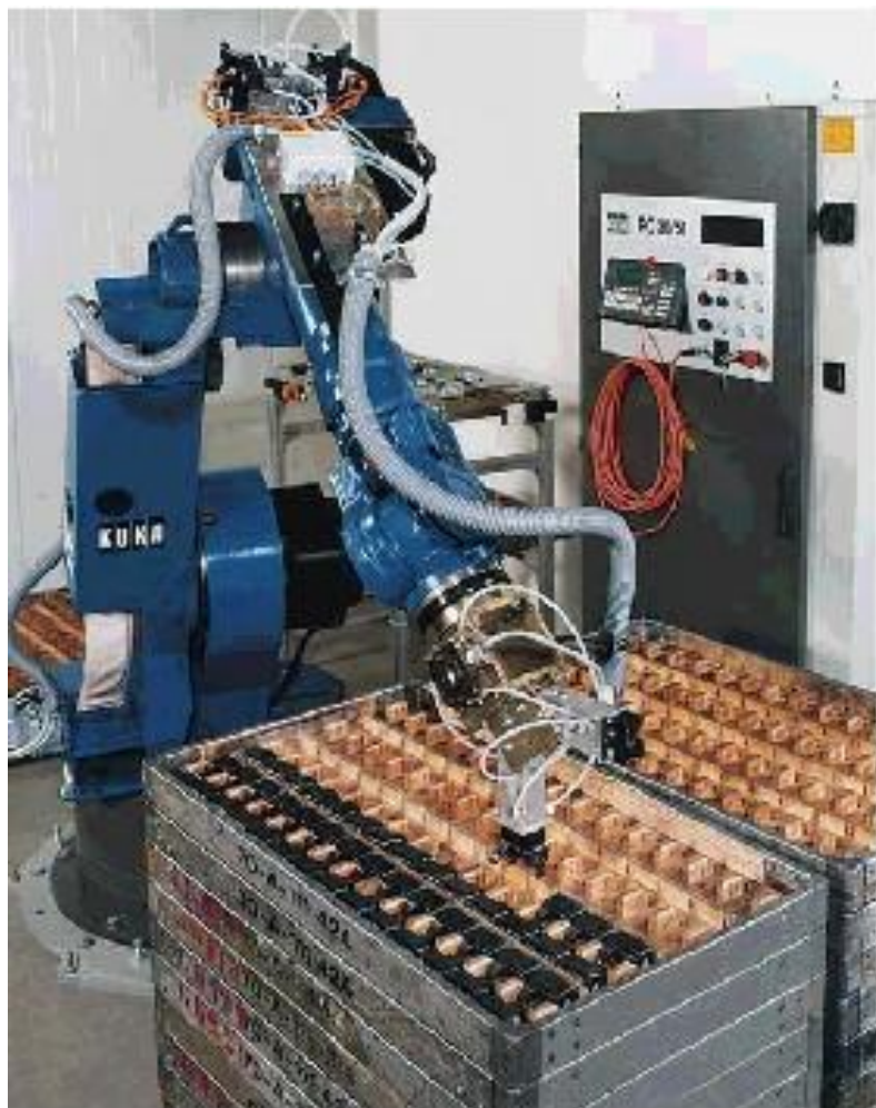
Slika 24: Primjena robota pri pakovanju
