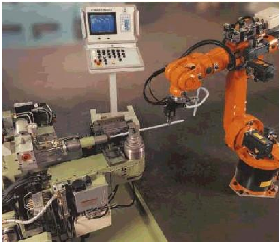
Slika 16: Primjena robota za premještanje pri proizvodnji žice
