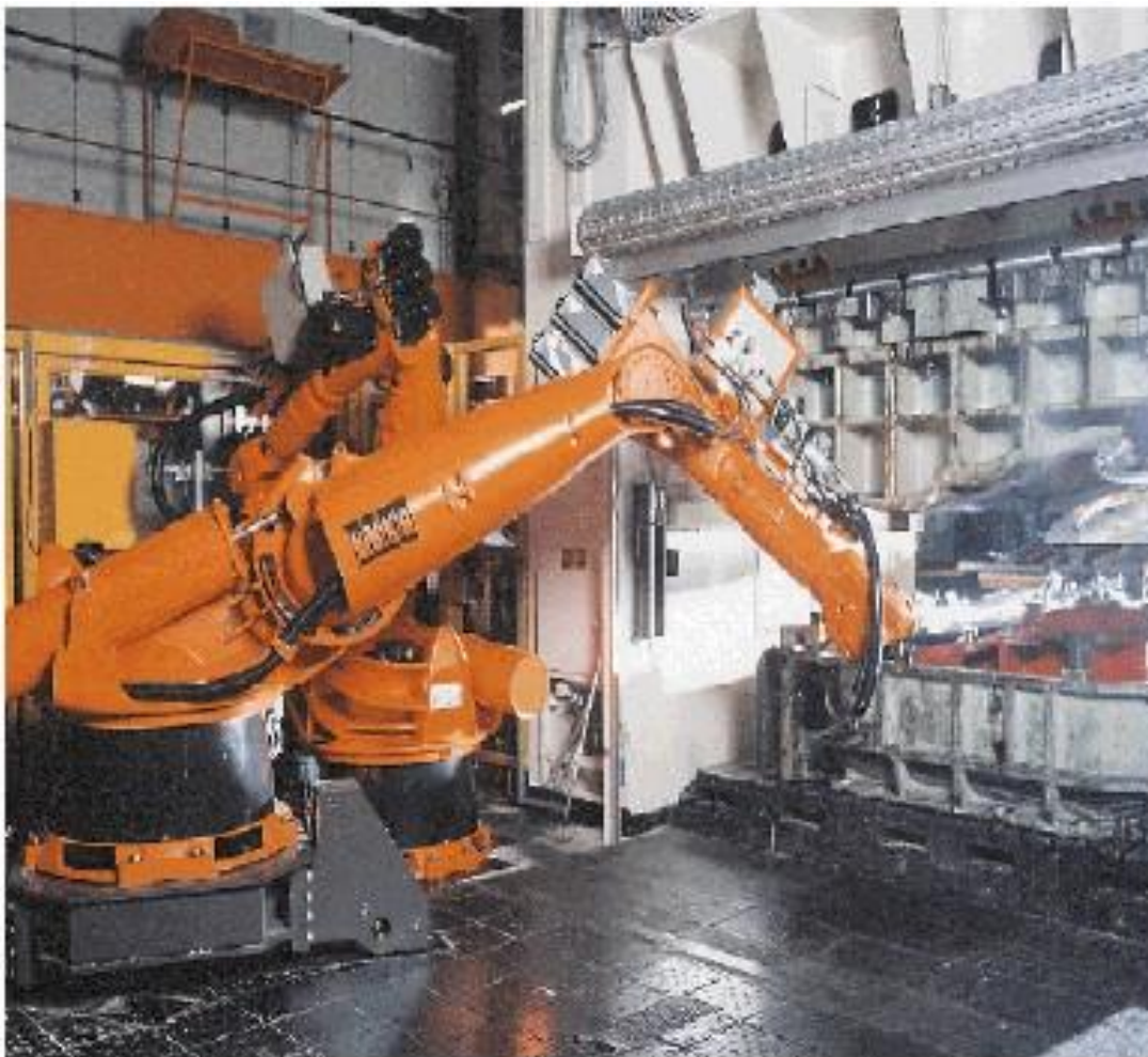
Slika 31: Primjena robota pri opsluživanju prese
