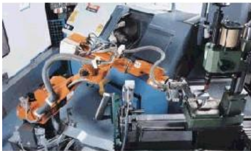
Slika 27: Primjena robota pri opsluživanju alatnih mašina
