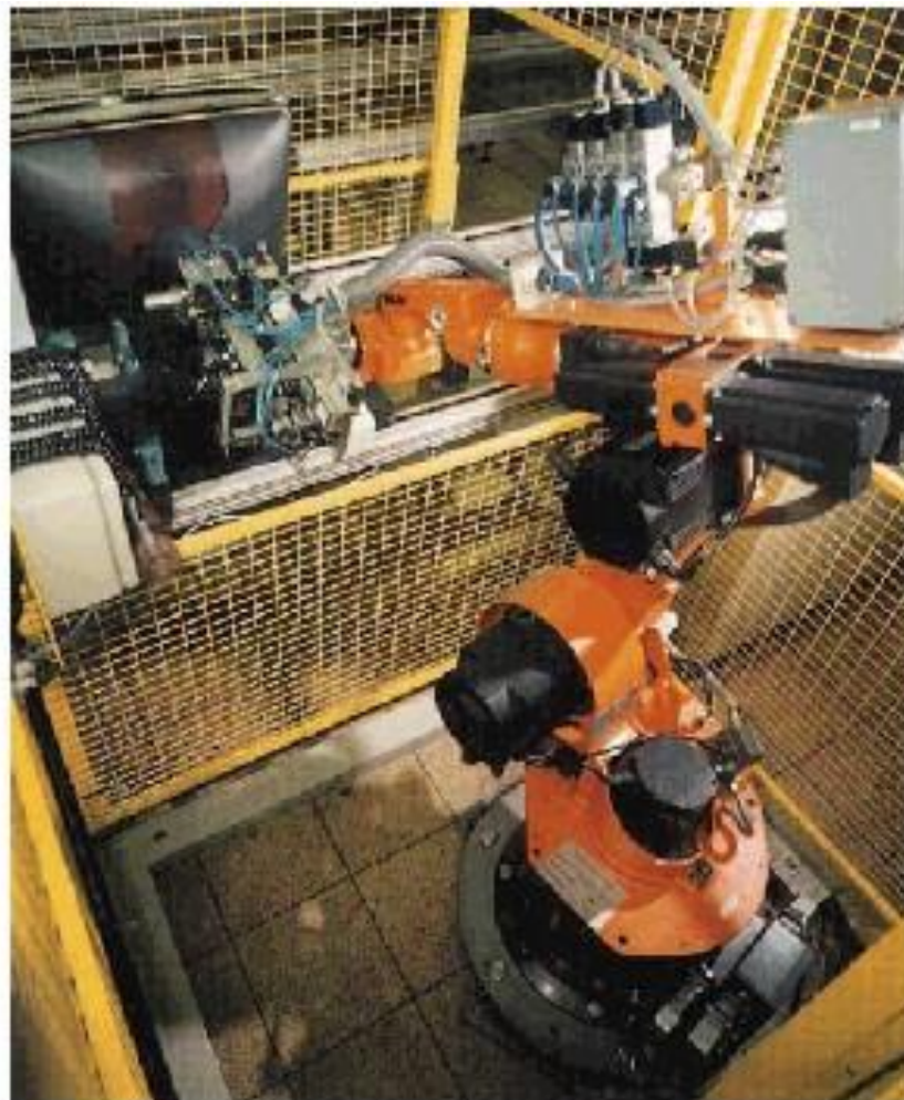
Slika 23: Primjena robota pri montaži katodnih cijevi televizora
