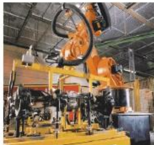
Slika 32: Primjena robota pri premještanju dijelova automobila
