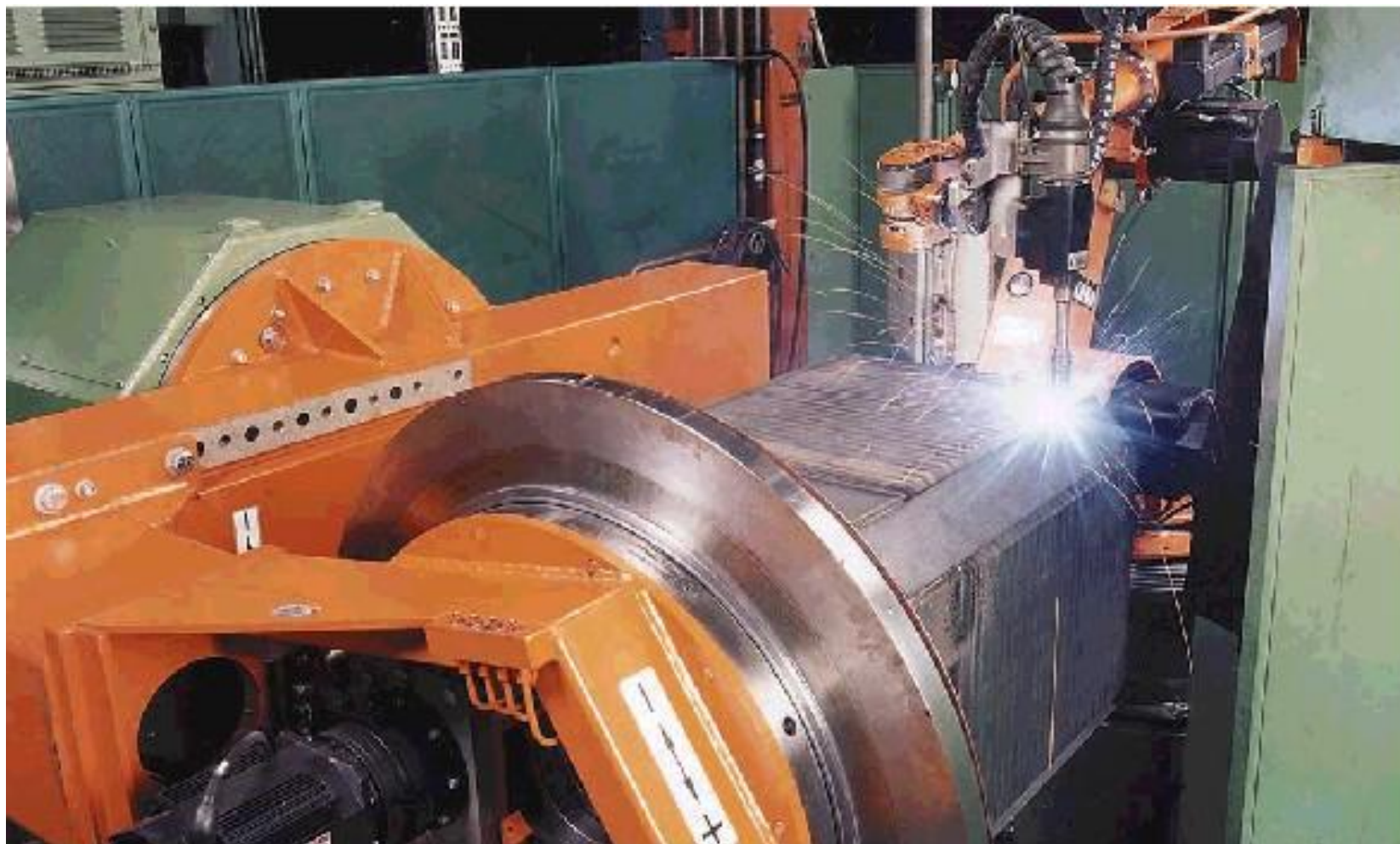
Slika 18: Primjena robota pri MIG/MAG zavarivanju
