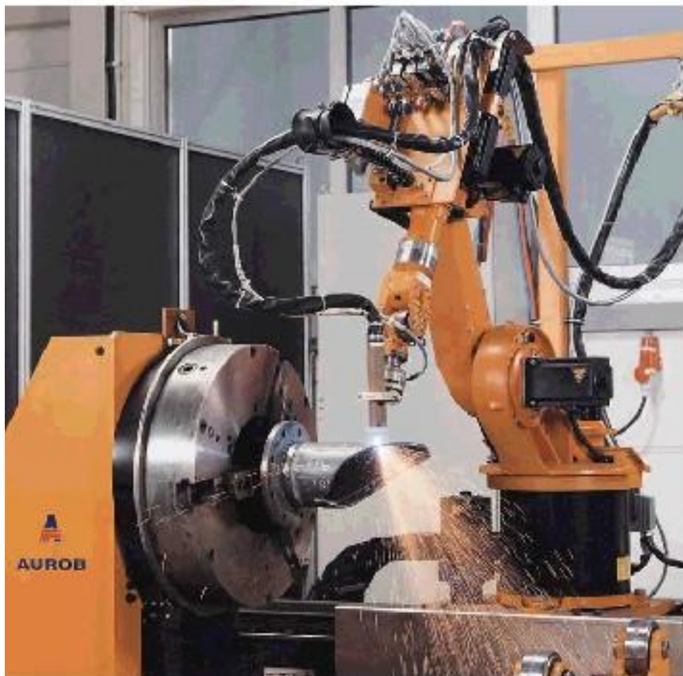
Slika 15: Primjena robota pri plazma rezanju cijevi
