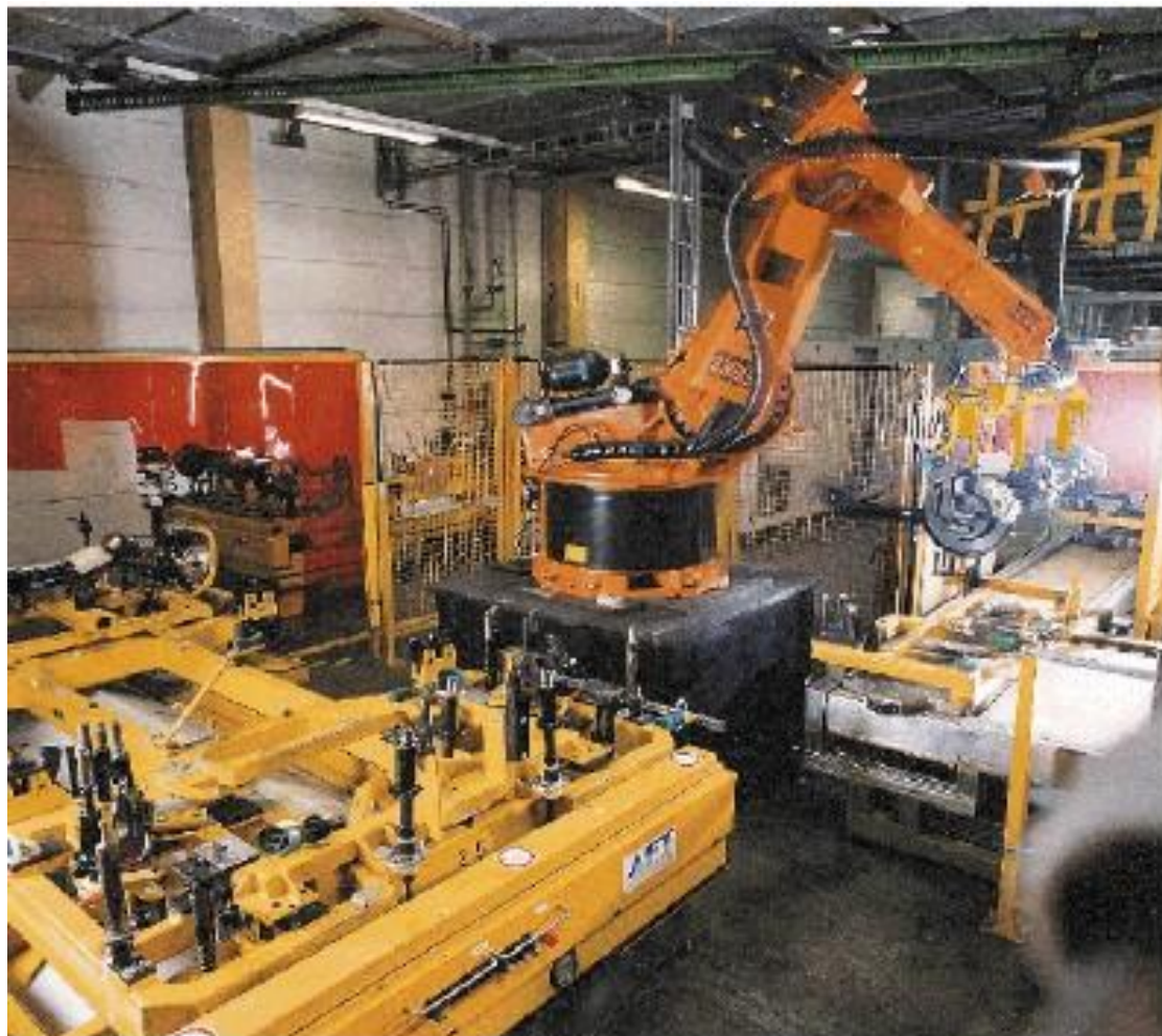
Slika 32: Primjena robota pri premještanju dijelova automobila
