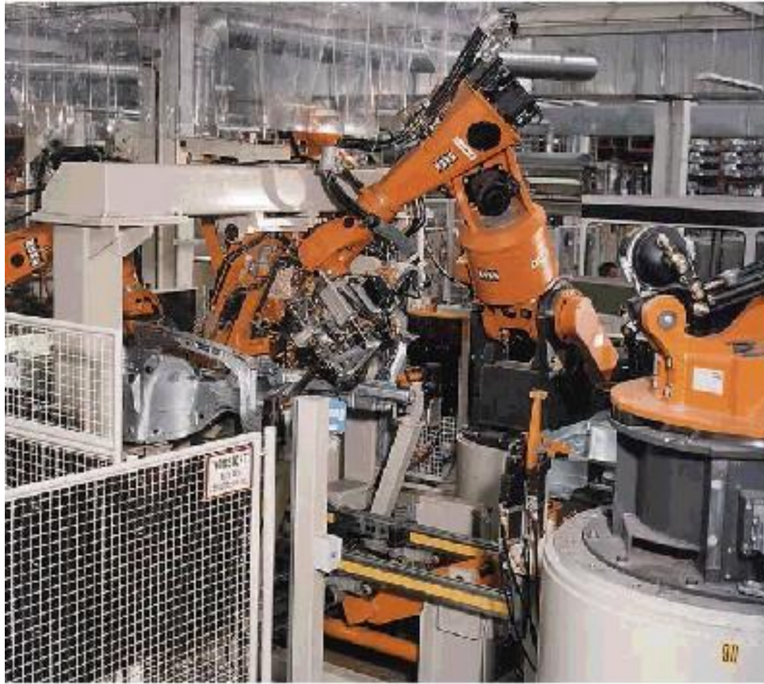
Slika 25: Primjena robota pri tačkastom zavarivanju automobila
