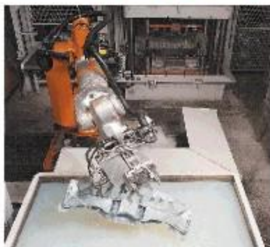
Slika 17: Primjena robota pri odlaganju odlivaka
