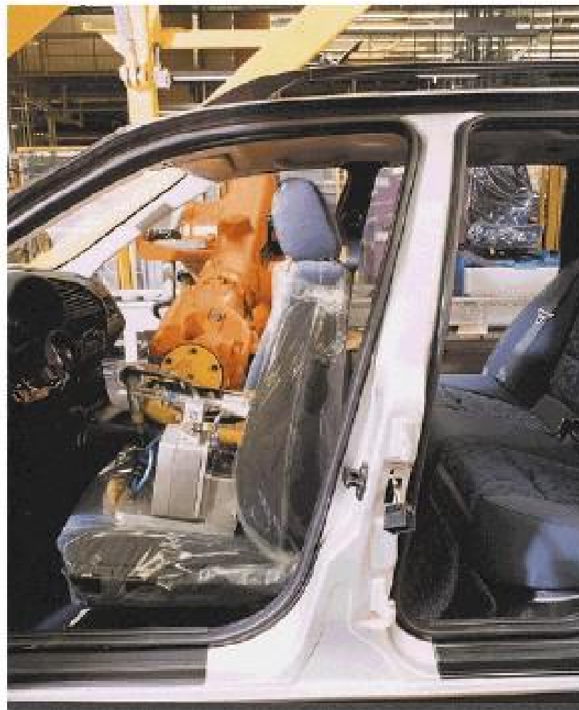
Slika 35: Primjena robota pri montaži sjedišta u automobilu
