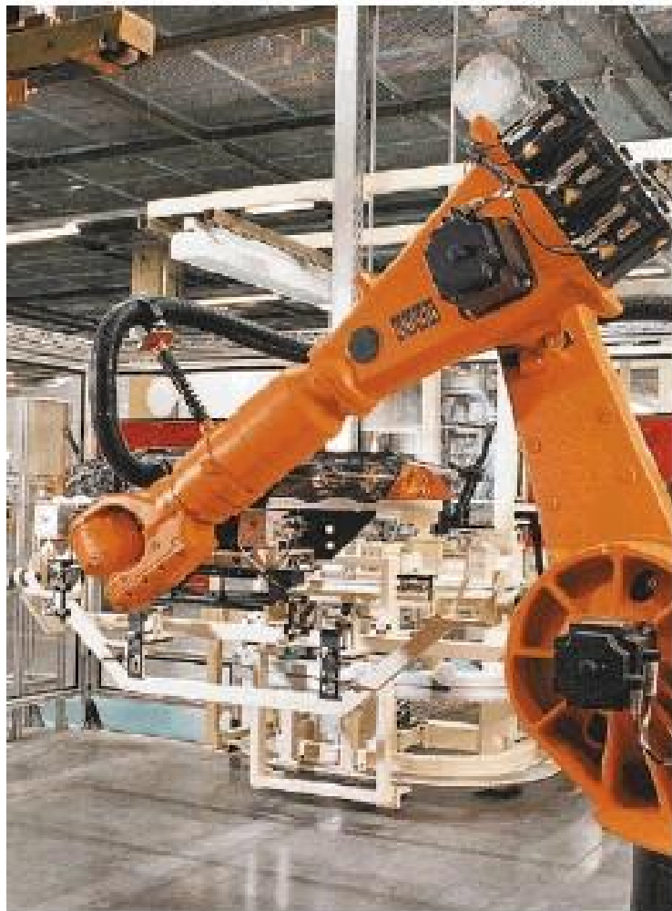
Slika 28: Primjena robota pri premještanju branika za automobile
