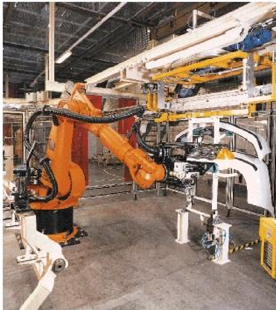
Slika 28: Primjena robota pri premještanju branika za automobile
