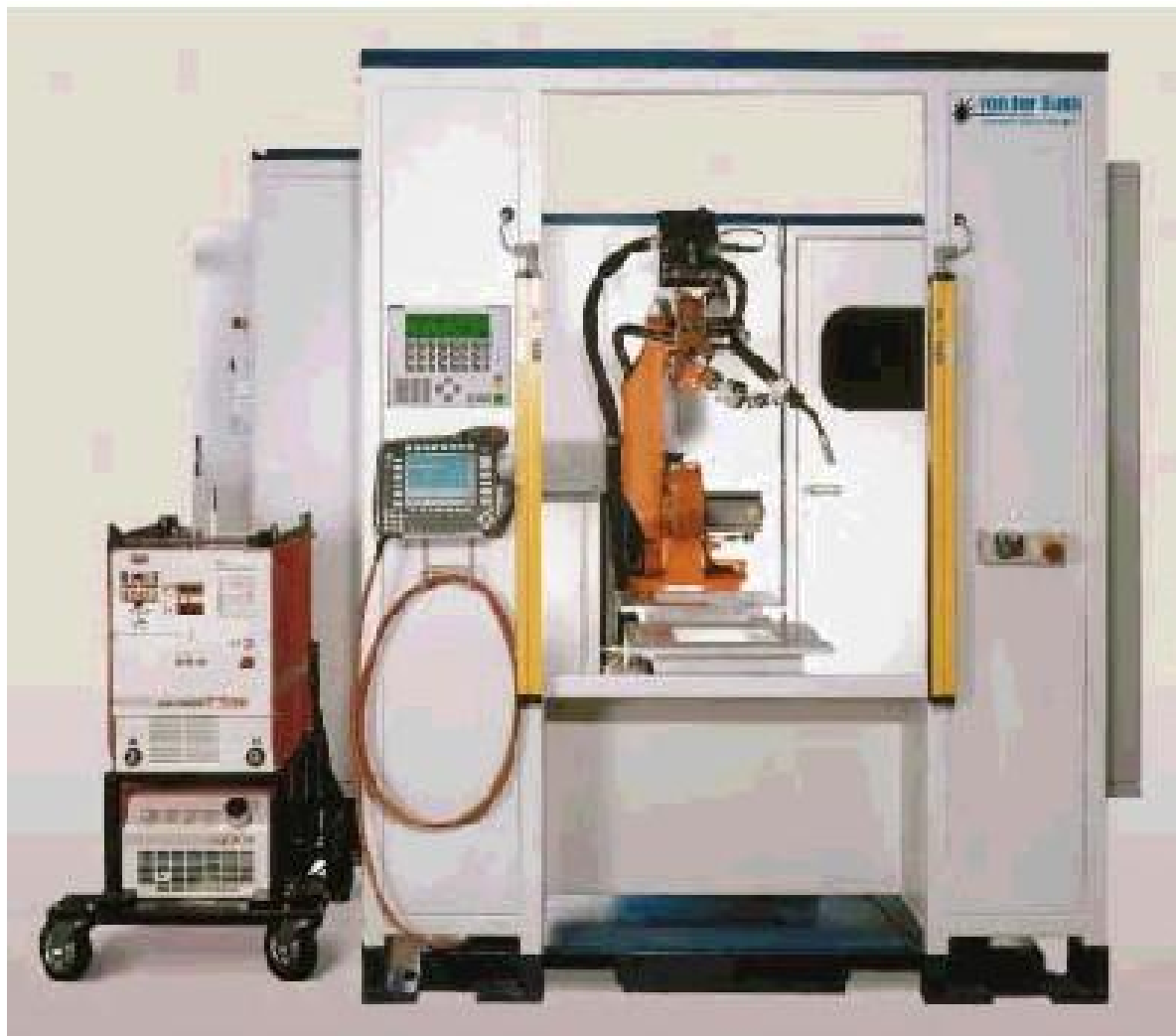
Slika 22: Primjena robota pri MAG zavarivanju u malim unutrašnjim otvorima
