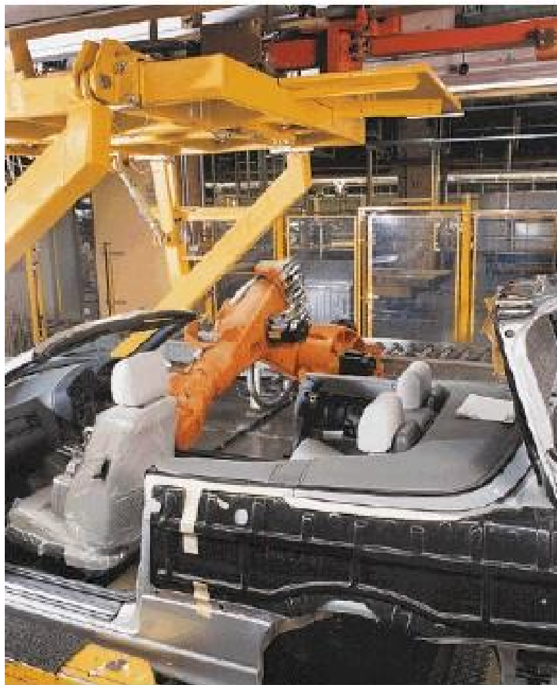
Slika 35: Primjena robota pri montaži sjedišta u automobilu
