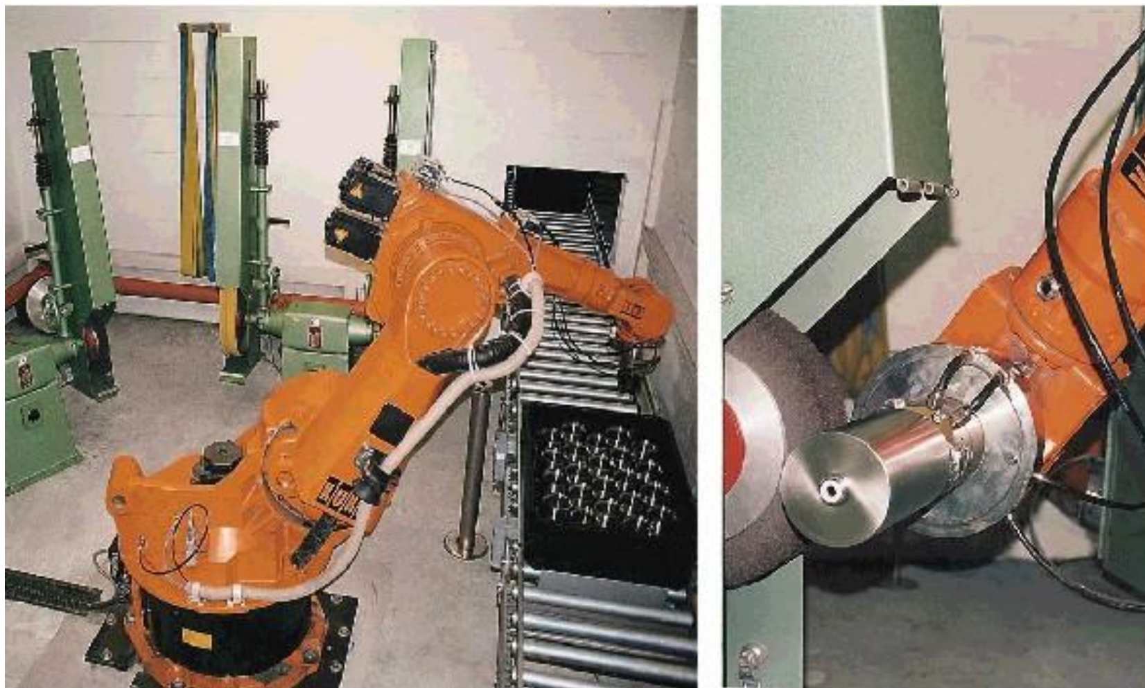
Slika 20: Primjena robota pri brušenju i poliranju
