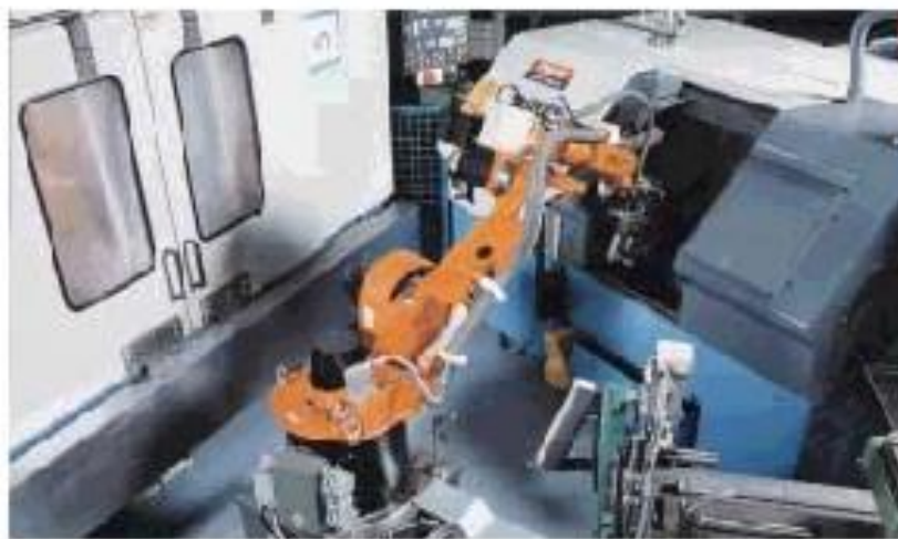
Slika 27: Primjena robota pri opsluživanju alatnih mašina
