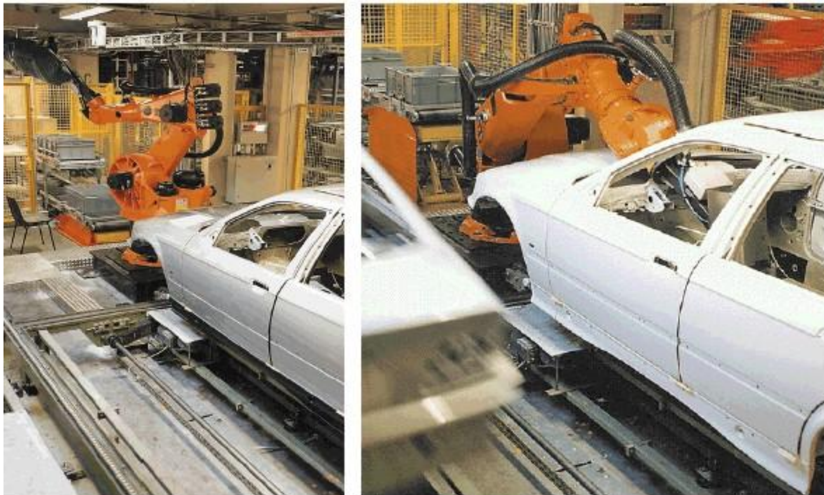
Slika 33: Primjena robota pri montaži električne instalacije u automobilu
