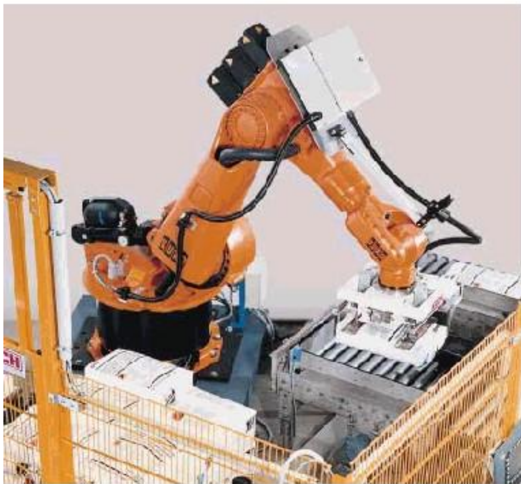
Slika 8: Primjena robota pri paletiranju
