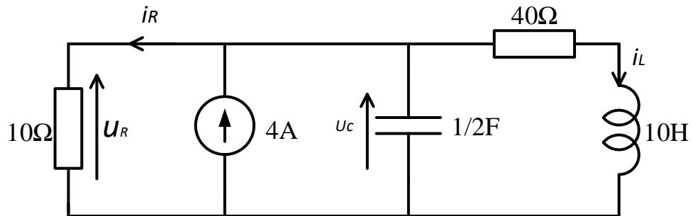
$$4 = i_R + i_C + i_L \Rightarrow i_L = 4 - i_R - i_C = 4 - \frac{u_R}{10} - C \frac{du_C}{dt}$$
