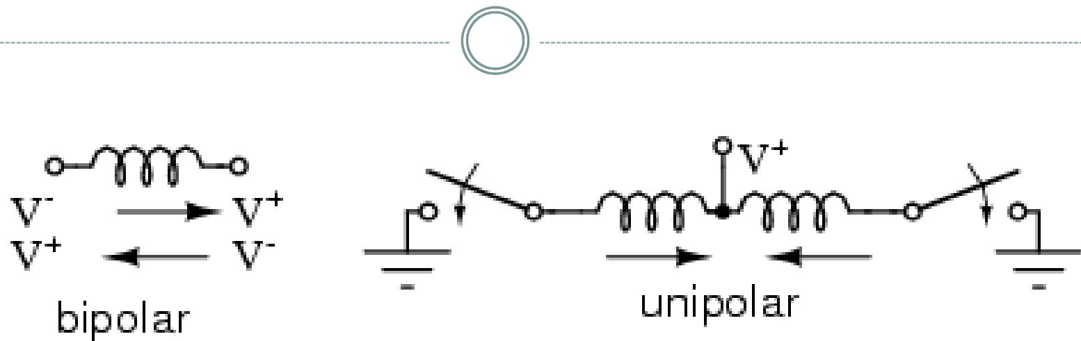
Jedan bipolarni namotaj zamjenjuje 2 unipolarna.
