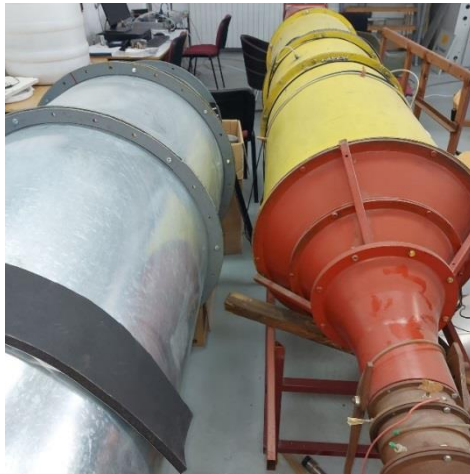
Slika 1. Aero tunel za kalibraciju sonde za mjerenje brzine vazduha
