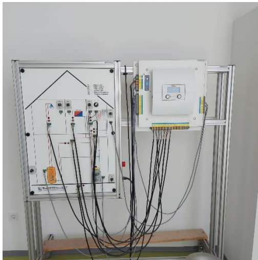
Slika 7. Instalacija za simulaciju i kontrolu sistema centralnog grijanja i pripreme STV.
