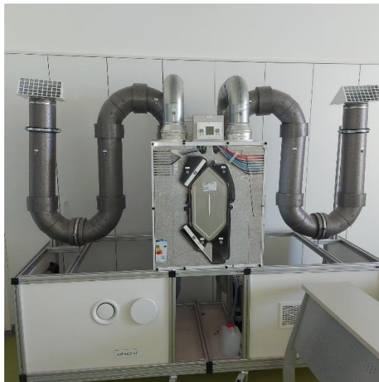
Slika 8. Instalacija za demonstraciju rekuperacije kod vazdušnih sistema grijanja
