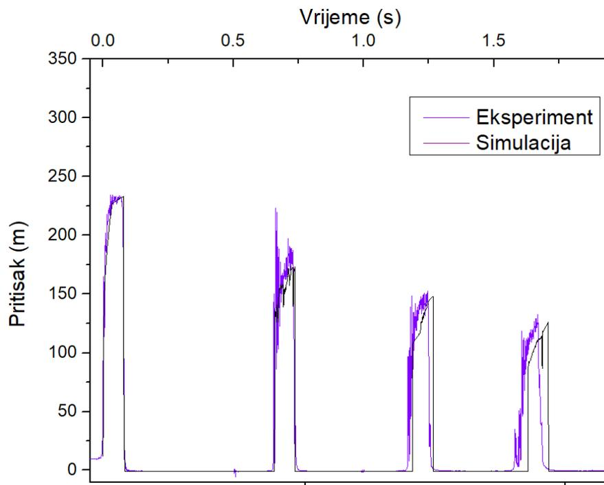
*Slika 6. Poređenje rezultata eksperimenta i simulacije*
