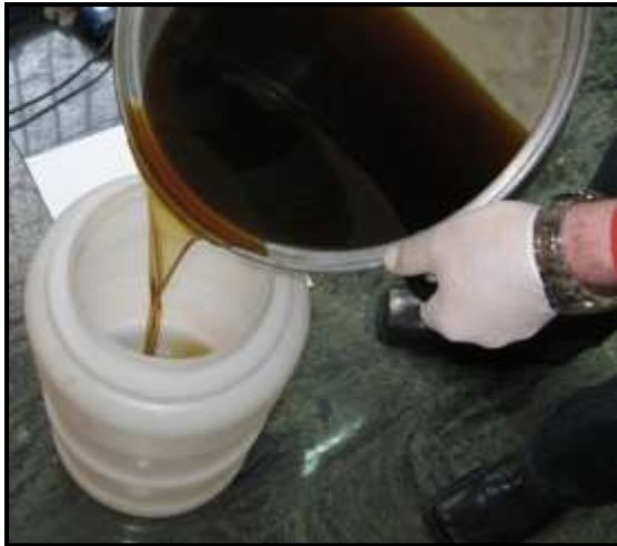
Slika 31. Miješanje smješe metanol i NaOH
