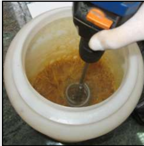
Slika 32. Miješanje smješe metanol i NaOH
