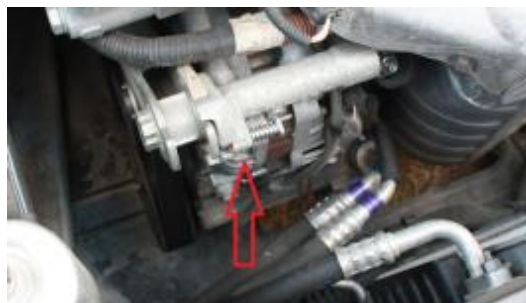
Kontrola učvršćenja alternatora
