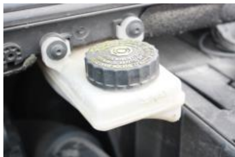
Kočioni uređaj - Potrebno je kontrolisati količinu tečnosti i spojenost svih elemenata uređaja
