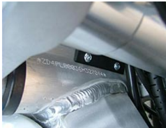
Slika 1.2.b Izgled broja šasije kod motocikla
