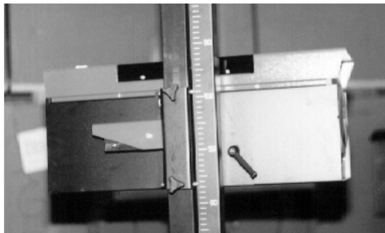
Slika 11.4. Optička kutija sa polugama za podešavanje visine i nagiba.
