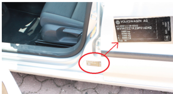
Slika 1.8. VIN oznaka na tipskoj pločici Golf VI.
