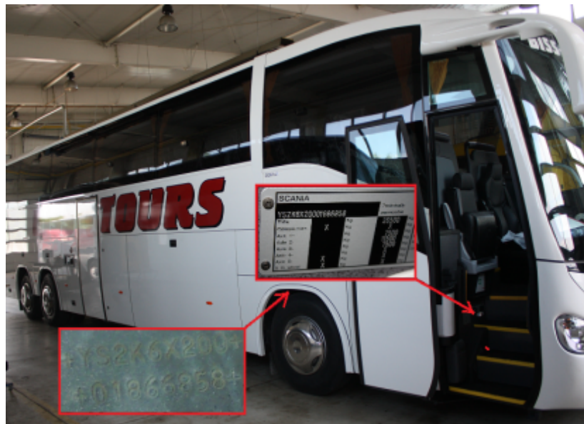
Slika 1.13. Mjesto VIN oznake SCANIA IRIZAR.
