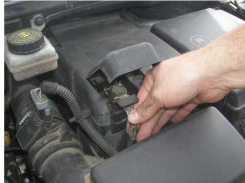
Kontrola učvršćenosti akumulatora
