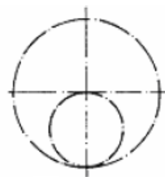
Cilind. zup. par sa unutrašnjim ozubljenjem
