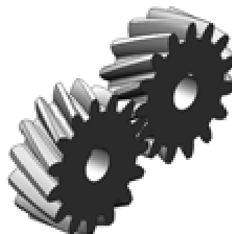
Cilindrični zupčasti par: - pravi zubi - kosi zubi
