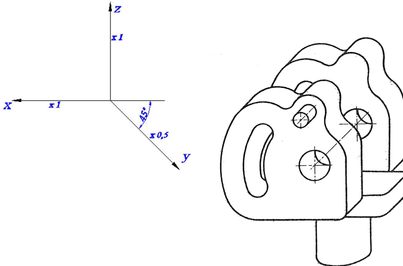
Kosa projekcija se koristi kada na čeonoj površini ima veliki broj kružnica, pa se crtaju kružnice i kružni lukovi, a ne elipse i eliptični lukovi.
