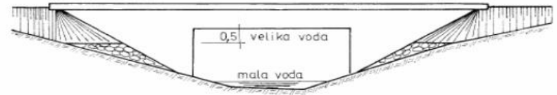
IZGLJED PLOČASTOG PROPUSTA SA PARALELNI KRILNIM ZIDOVIMA
