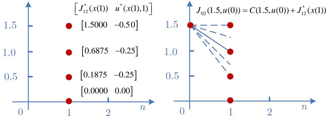
Na primjer, pretpostavimo da su upravljanja diskretizovana sa korakom 0.25:  $u(n) \in \{-1.0, -0.75, -0.5, -0.25, 0, 0.25, 0.5, 0.75, 1.0\}$ . Vrijednosti optimalnih cijena i upravljanja kada se kreće iz stanja  $x(1)$  su prikazana na gornjoj slici, lijevo.
