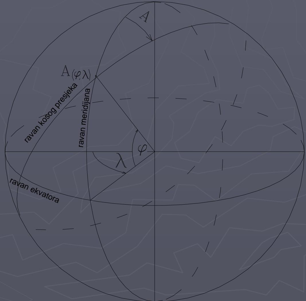
Azimut se na Zemljinoj površi može mjeriti kao ugao u horizontalnoj ravni koji zaklapaju tangenta na meridijan povučena u tjemenu ugla sa tangentom na geodetsku liniju koja prolazi kroz tačke C i D, takođe povučenom iz tjemena ugla.
