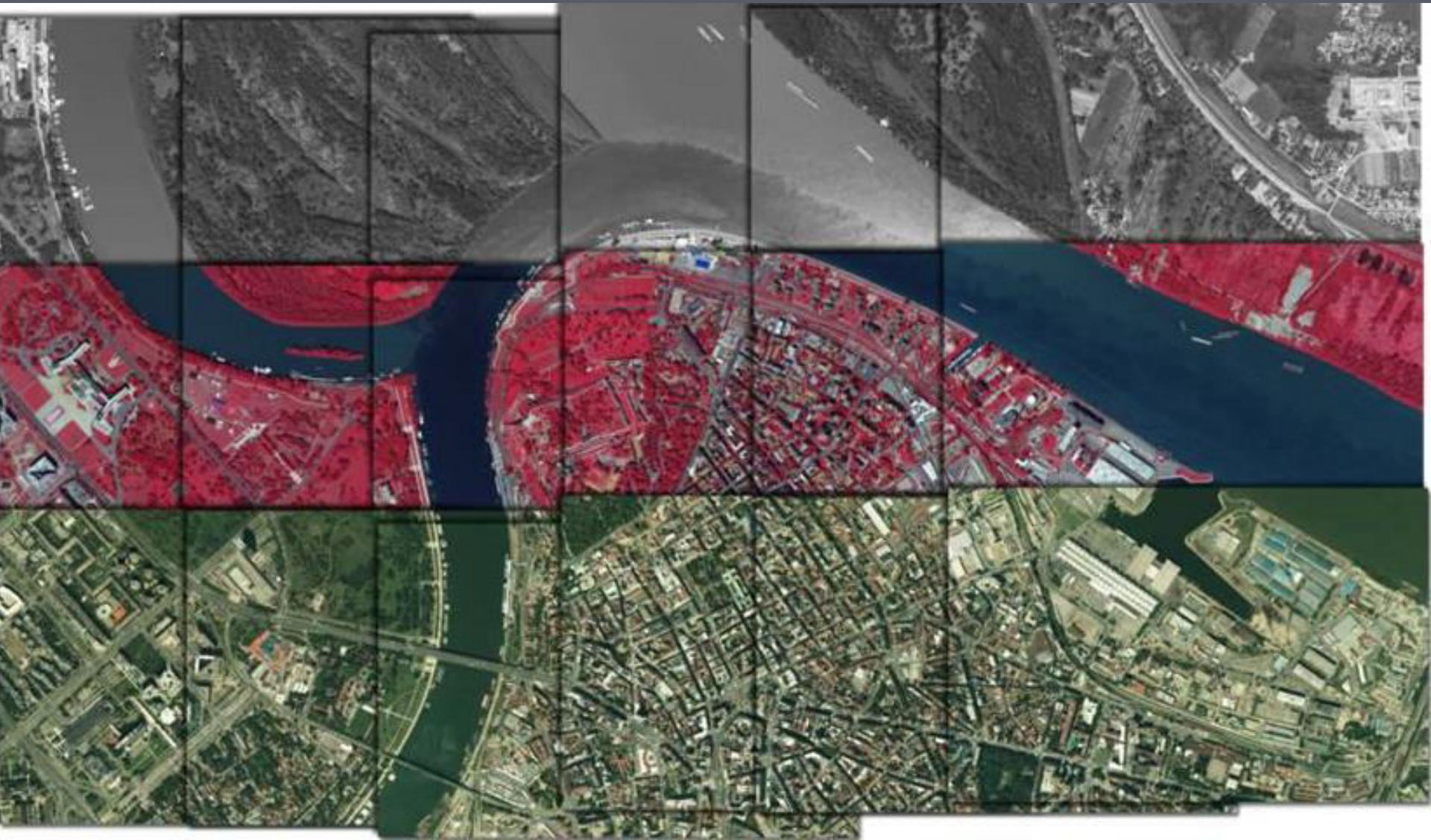
Digitalni ortofoto plan (DOF) je georeferencirana digitalna slika dijela površi Zemlje određenih dimenzija koja ima karakteristike ortogonalne projekcije, dobijena postupkom ortorektifikacije digitalnih aerofotogrametrijskih snimaka, digitalnih satelitskih snimaka ili snimaka dobijenih ostalim metodama daljinske detekcije.
