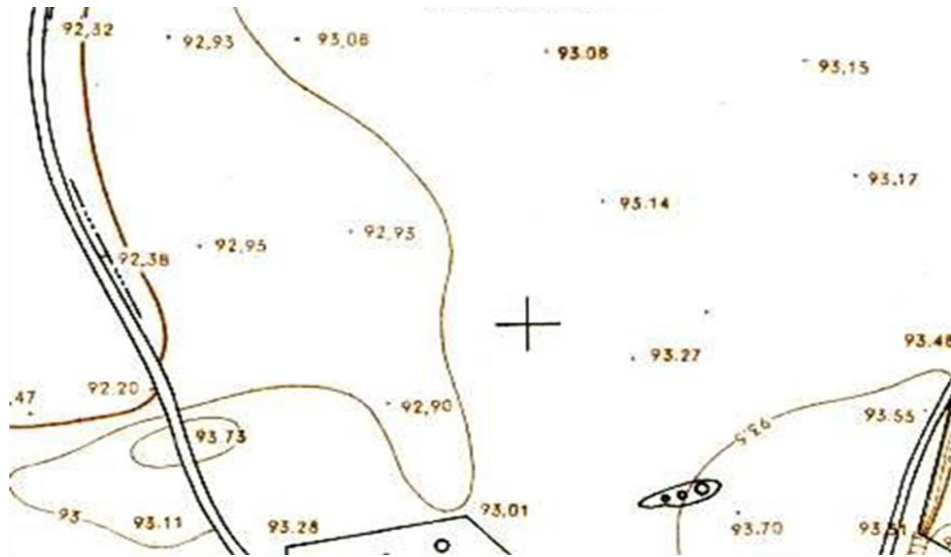
Slika 3. Prikazivanje reljefa metodom kota u kombinaciji sa izohipsama
