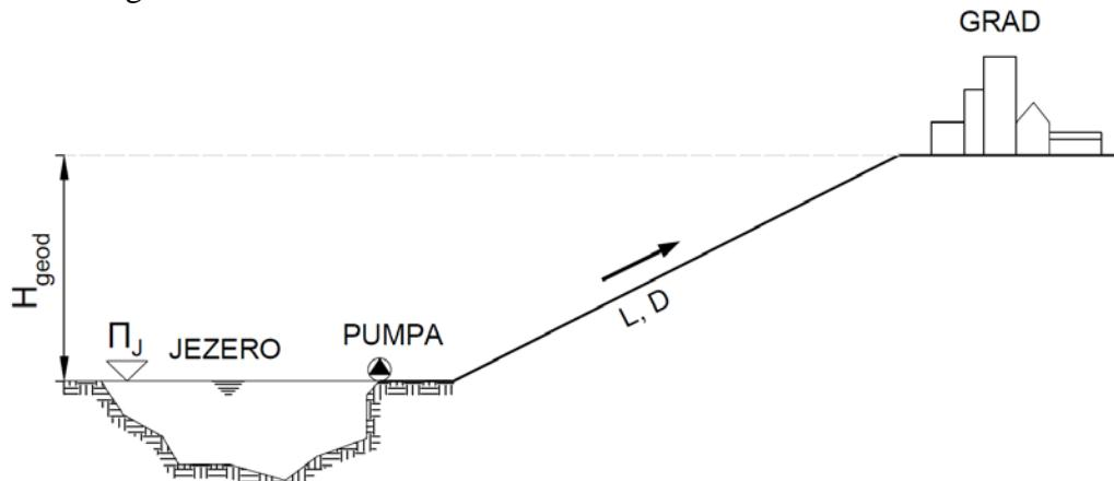
Hidraulička dispozicija: Voda se iz jezera pumpa ka potrošačima u gradu koji se nalazi na višoj koti.
