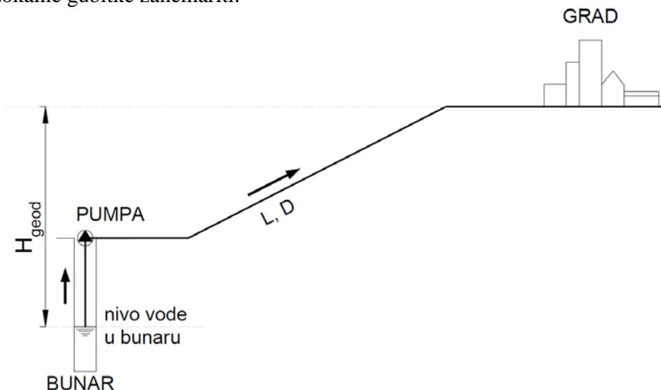
*Hidraulička dispozicija: Voda se iz bunara pumpa ka potrošačima u gradu.*
