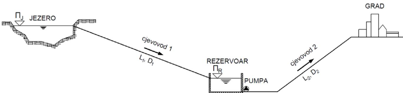
Hidraulička dispozicija: Rezervoar se puni iz jezera sa više kote, preko dovodnog cjevovoda 1. Voda se iz rezervoara pumpa dalje ka potrošačima u gradu preko cjevovoda 2.
