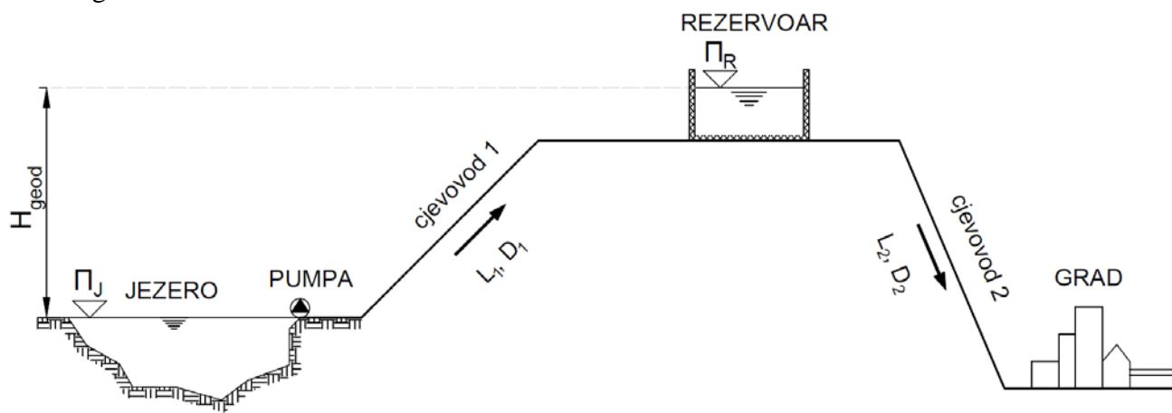
*Hidraulička dispozicija: Voda se iz jezera pumpa u rezervoar (cjevovod 1), a odatle se dalje distribuira potrošačima u gradu (cjevovod 2).*
