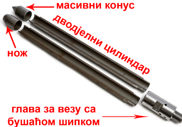
Слика 2. Кашика за стандардни пенетрациони тест (SPT sampler, split spoon)
