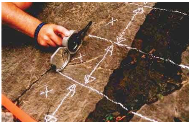
Слика 21: Мјерење падног угла равни слоја геолошким компасом
