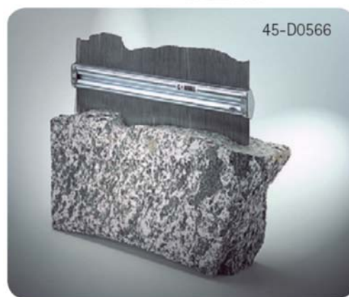
Слика 25: Типични профили храпавости, Мјерење храпавости дисконтинуитета – профилометар (Бартонов чешаљ)
