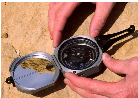
Слика 20: Геолошки компас са клинометром за мјерење пружања, азимута и падног угла (Брунтонов компас)
