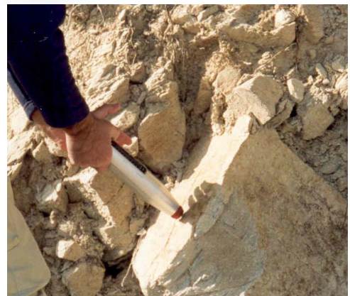
Слика 6: Пројена притисне чврстоће зида дисконтинуитета коришћењем Шмитовог чекића
