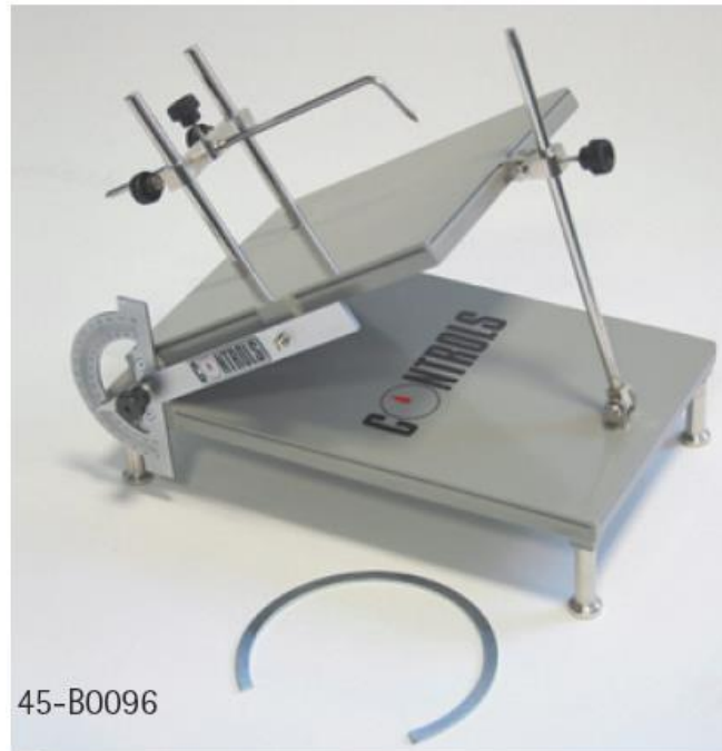
Слика 5: Мјерење хрававости дисконтинуитета – tilt test
