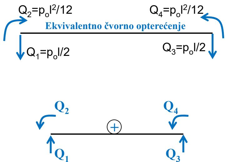
$$Q = \begin{bmatrix} Q_1 \\ Q_2 \\ Q_3 \\ Q_4 \end{bmatrix} = \begin{bmatrix} -p_o \frac{l}{2} \\ -p_o \frac{l^2}{12} \\ -p_o \frac{l}{2} \\ p_o \frac{l^2}{12} \end{bmatrix}$$
