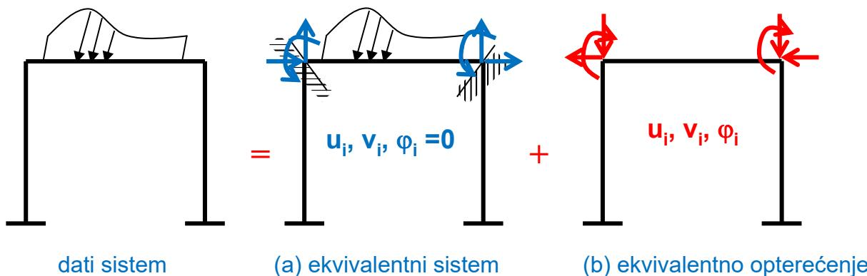
Na slici (a) štapovi su opterećeni opterećenjem usled kojeg se određuju reaktivne sile i momenti uz pretpostavku da su  $u_i, v_i, \varphi_i = 0$ .
