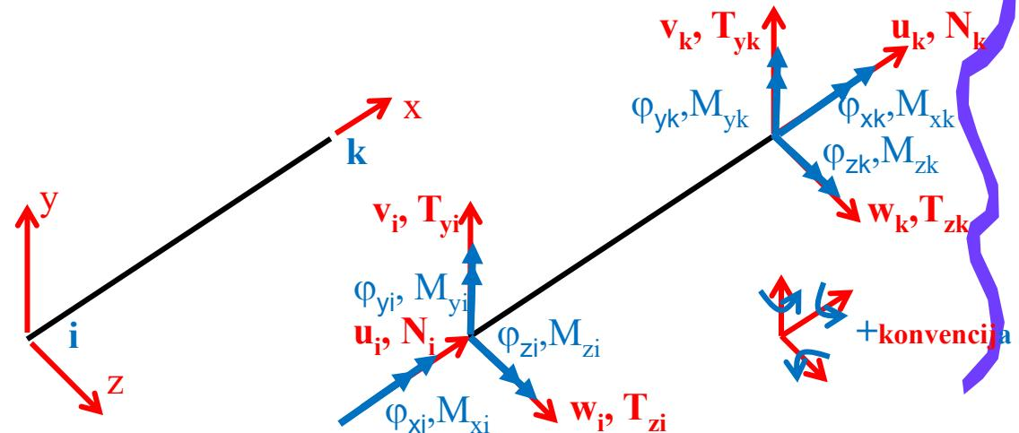
Osnovne kinematicke velicine u čvorovima su generalisana pomjeranja  $u$ ,  $v$ ,  $w$  u pravcima  $x$ ,  $y$ ,  $z$  i obrtanja  $\varphi_x$ ,  $\varphi_y$ ,  $\varphi_z$  oko osa  $x,y,z$ , respektivno.
