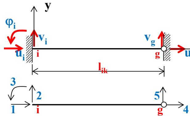
$$\begin{bmatrix} S_{ik} \\ M_i \\ M_k \end{bmatrix} = \begin{bmatrix} k_{11}^o & & \\ & k_{22}^o & k_{23}^o \\ & k_{32}^o & k_{33}^o \end{bmatrix} \begin{bmatrix} \Delta l \\ \tau_i \\ \tau_k \end{bmatrix} = \begin{bmatrix} \frac{1}{\delta_{ik}} \\ a_{ik} & b_{ik} \\ b_{ki} & a_{ki} \end{bmatrix} \begin{bmatrix} \Delta l \\ \tau_i \\ \tau_k \end{bmatrix}$$
