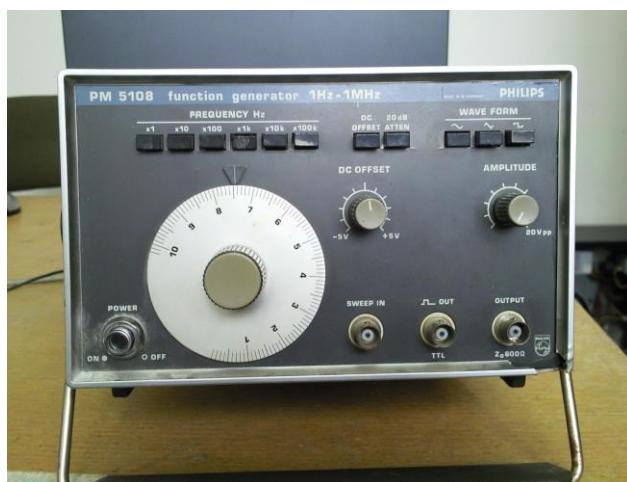
2. Generator funkcija Philips PM 5108
