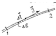
Neka je ostvaren strujni tok u tankom žičanom provodniku. Pošto je provodnik tanak možemo pretpostaviti da je struja ravnomjerno raspoređena po površini poprečnog presjeka. A pošto je sredina provodna možemo pisati, na osnovu gornje relacije
