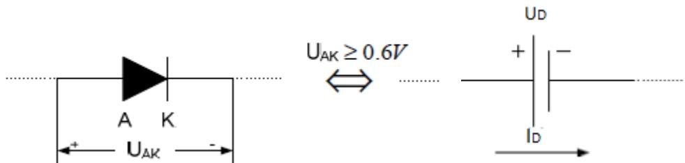
II – Napon na p-n spoju  $U_{AK} < 0.6 V$  nije dovoljan za savladavanje potencijalne barijere ili je diode inverzno polarisana. U ovom slučaju dioda ne provodi, nema struje kroz nju  $I_D = 0A$ , i predstavlja prekid u kolu (otvoreni prekidač).
