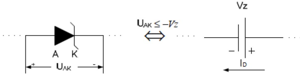
Polaritet baterije je suprotan u odnosu na slučaj kada je dioda direktno polarisana i provodi.
