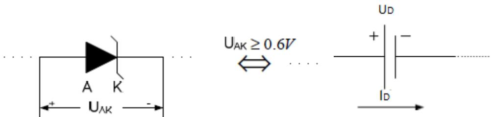
II – Napon na p-n spoju  $U_{AK} < 0.6V$  nije dovoljan za savladavanje potencijalne barijere ili je diode inverzno polarisana ali naponom  $U_{AK} > -V_z$  koji nije dovoljan da dovede do zener-ovog probaja. U ovom slučaju dioda ne provodi, nema struje kroz nju  $I_d = 0A$ , i predstavlja prekid u kolu (otvoren prekidač).
