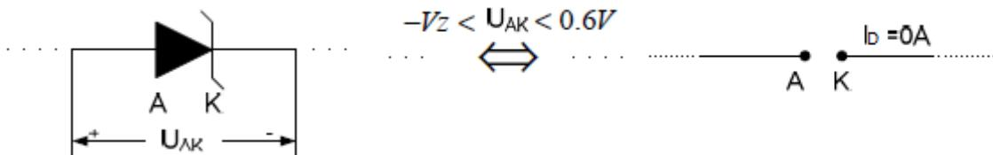
III - Ukoliko je dioda inverzno polarisana i taj napon je veći (po apsolutnoj vrijednosti) od napona  $V_z$   $U_{AK} \leq -V_z$  dioda će provesti. Zener dioda se najčešće koristi upravo u ovom režimu rada za stabilizaciju napona. Kada dođe do Zener-ovog probaja, dioda se zamjenjuje baterijom čija je elektromotorna sila jednaka naponu zenerovog probaja  $V_z$ .
