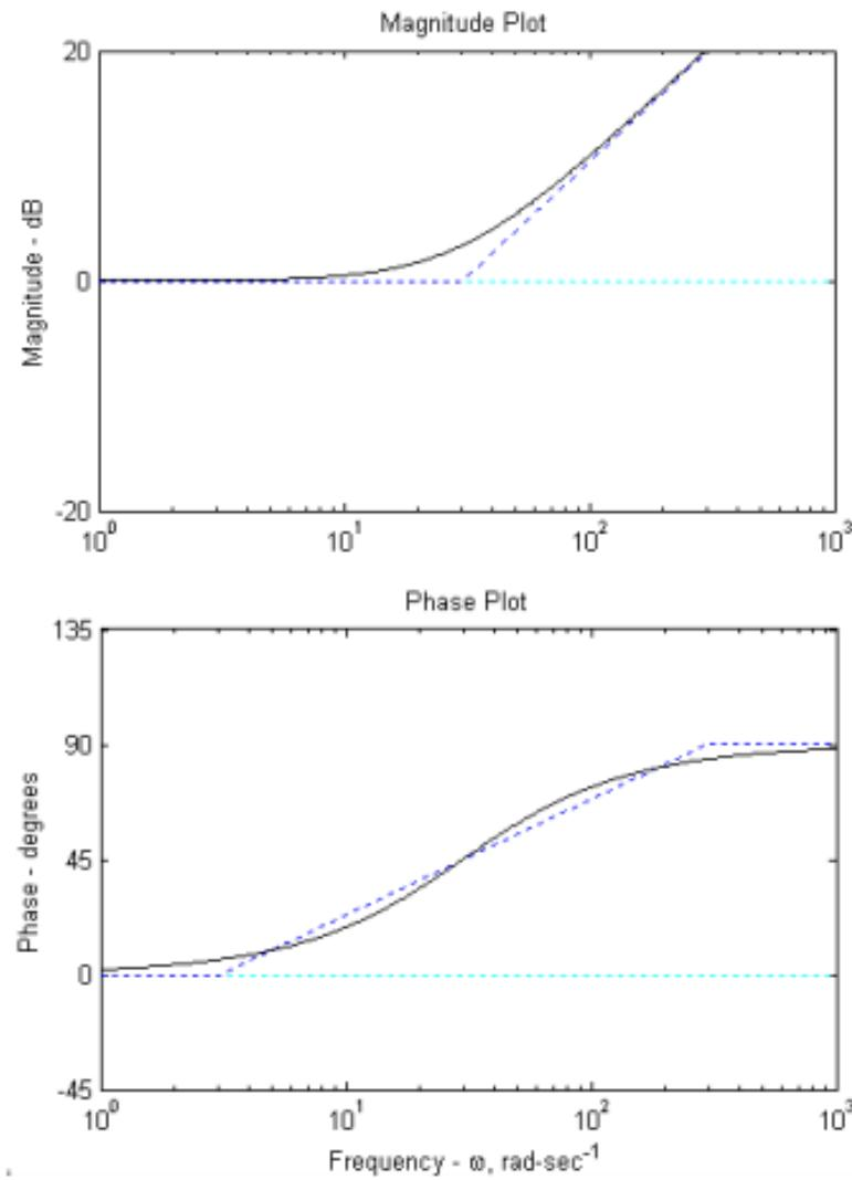
**Nula prenosne funkcije podiže nagib amplitudsko frekvencijske karakteristike za  $20\text{dB/dec}$**
