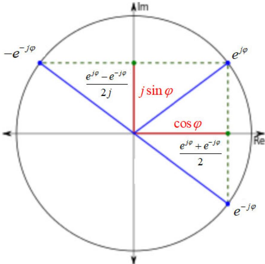
Sinusni (i kosinusni) talas je konstruisan iz dva rotirajuća vektora, koji rotiraju u suprotnim smjerovima (jedan smjer se smatra pozitivnom frekvencijom, a drugi negativnom)
