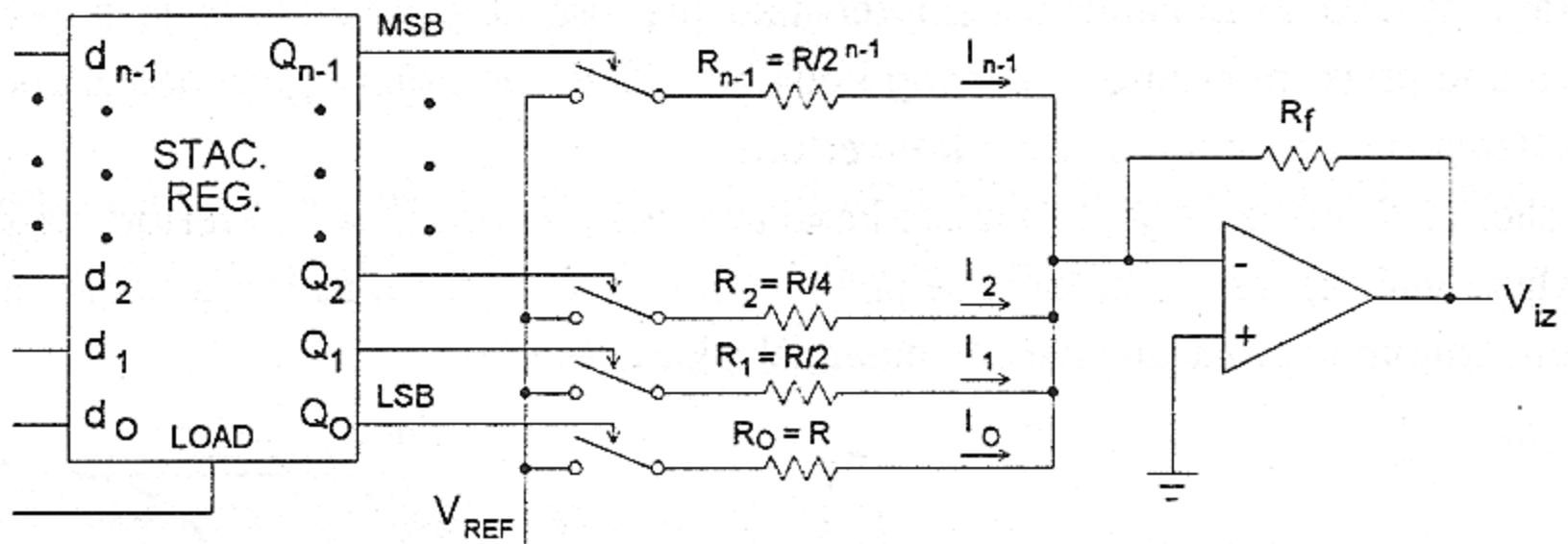
$$V_{iz} = -R_f \cdot V_{REF} \cdot \frac{1}{R} \cdot (2^0 \cdot Q_0 + 2^1 \cdot Q_1 + 2^2 \cdot Q_2 + \dots + 2^{n-1} \cdot Q_{n-1})$$
