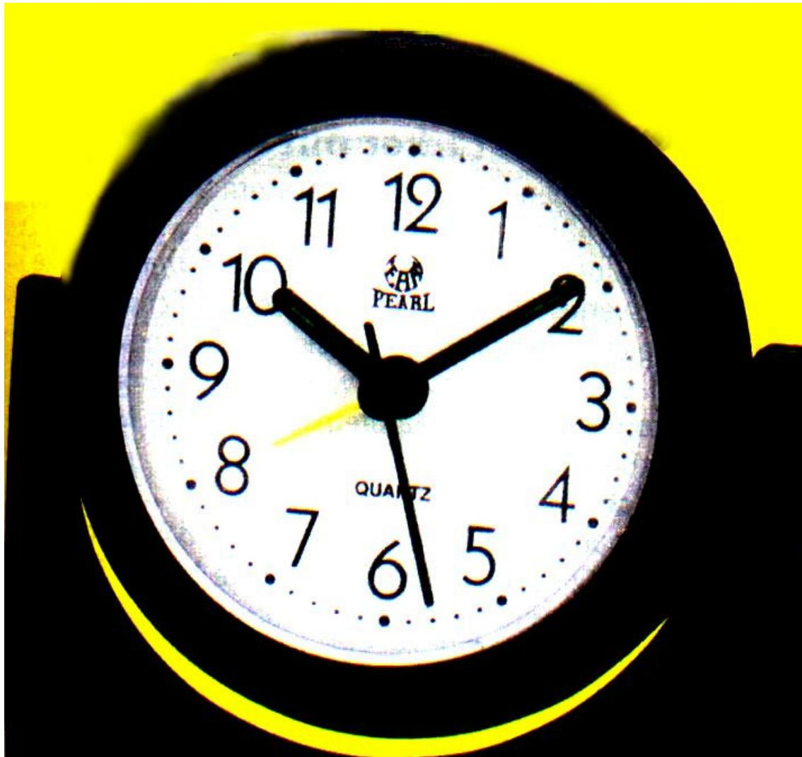
Digitalni časovnik sa kvarcnim kristalom pomoću koračnog motorića pretvara digitalnu informaciju o vremenu u analognu informaciju pomjeraja kazaljki. Čovjek lakše i brže registruje analogne informacije. Zato se analogni prikaz koristi i u automobilima, avionima, dispečerskim centrima, itd.
