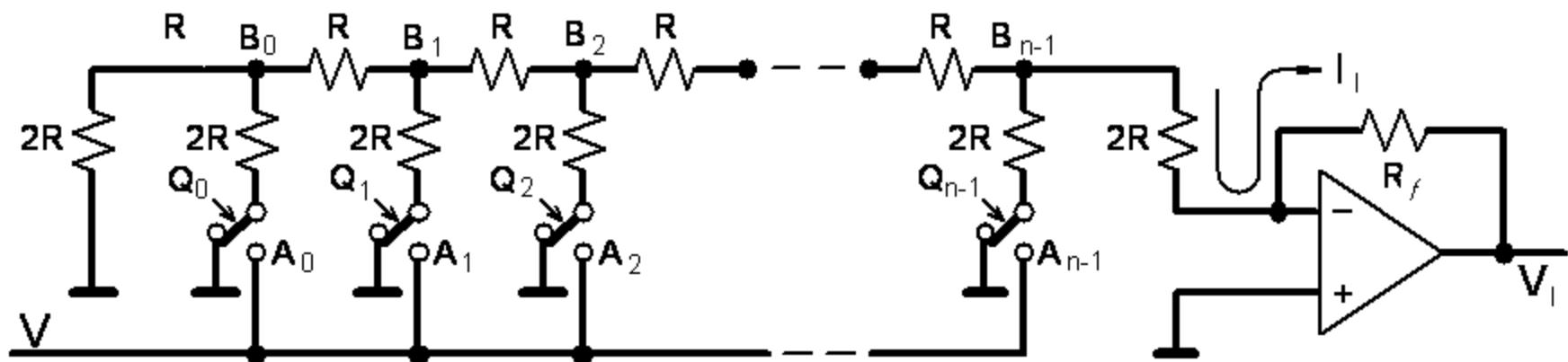
$$V_{iz} = -R_f \frac{V_{REF}}{6R} \cdot \frac{1}{2^{n-1}} \left( 2^{n-1} \cdot Q_{n-1} + 2^{n-2} \cdot Q_{n-2} + \dots + 2^2 \cdot Q_2 + 2^1 \cdot Q_1 + 2^0 \cdot Q_0 \right)$$
