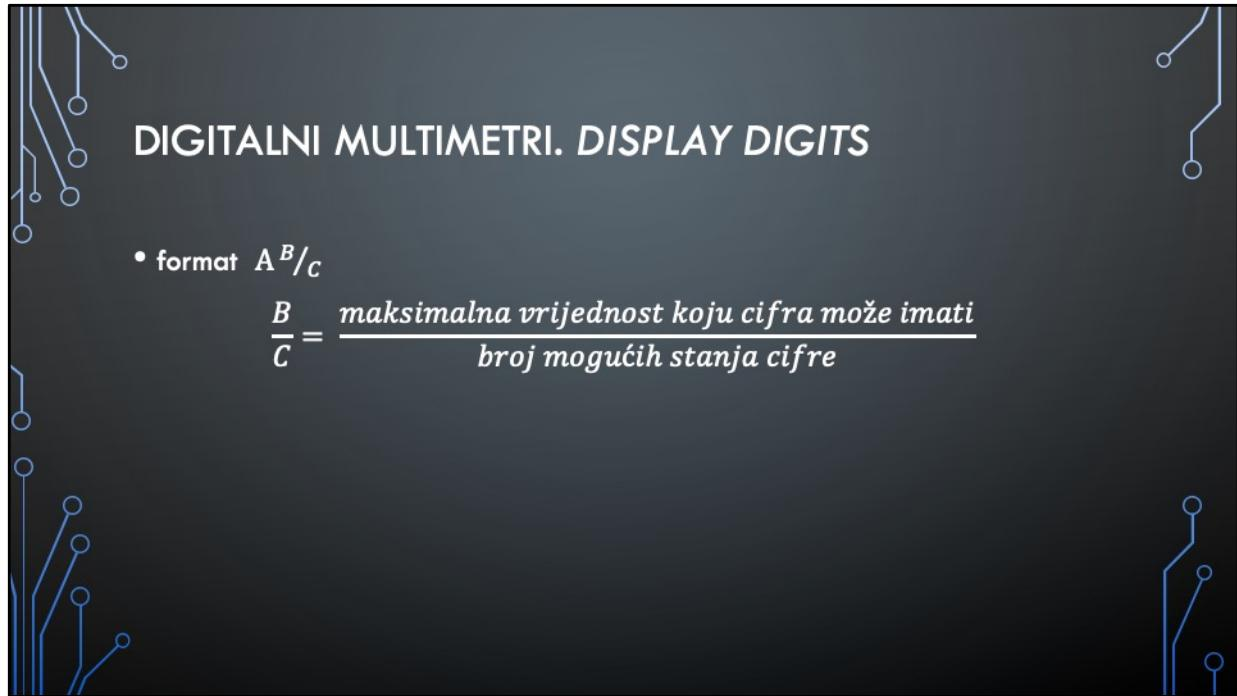
Digitalni multimetri (DMM) se mogu koristiti za različite vrste mjerena. Kada se vrši odabir DMM-a, ili se prvi put koristi DMM, najprije je potrebno obratiti pažnju na broj cifara instrumenta.
