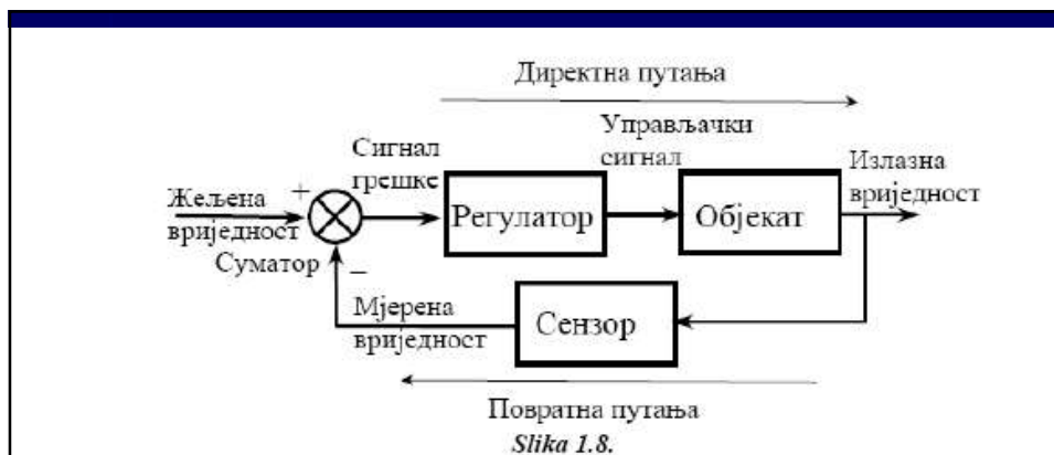
Sl. 1.8 prikazuje opšti blok dijagram za sistem u zatvorenoj sprezi, ili sistem upravljanja u zatvorenoj sprezi (eng. feedback control system ). Regulator i objekat se nalaze u direktnoj putanji toka informacija (signala), a senzor je u povratnoj putanji (vezi). Izmjerena vrijednost izlaza objekta se poredi u tački sumiranja sa željenom vrijednošću. Razlika, ili greška, se vodi u regulator koji generiše upravljački signal koji djeluje na objekat dok se njegov izlaz ne izjednači sa željenom vrijednošću. Ovakav pristup se nekada naziva sistem upravljanja po grešci.
