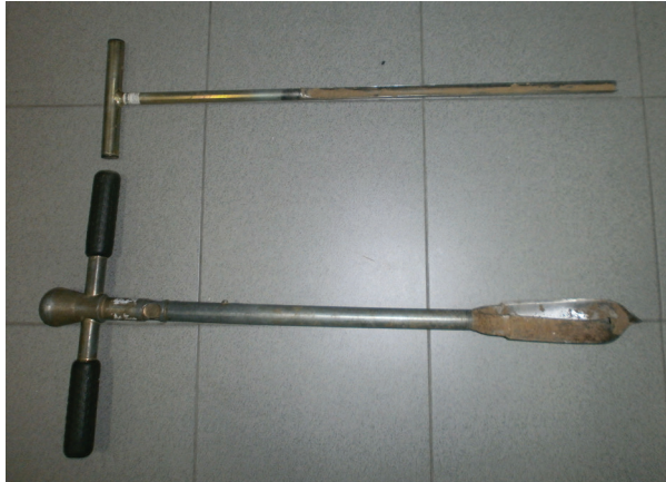
Slika 8. Sonda (gore) i svrdlo (dolje) za uzimanje uzoraka zemljišta (Bojanić Rašović)
