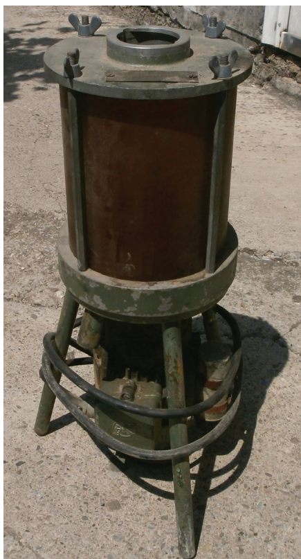
Slika 43. Fumigator starog tipa (proizvođač Metalska industrija Proleter, Arilje) (Bojanić Rašović)
