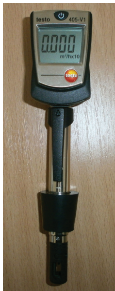
Slika 28. Anemometar i termometar (Bojanić Rašović)
