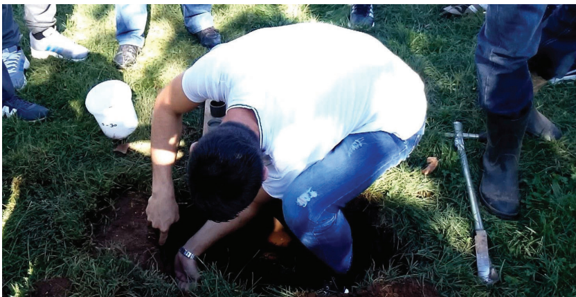
Slika 7. Uzimanje uzorka pedološkim nožem (Bojanić Rašović)
