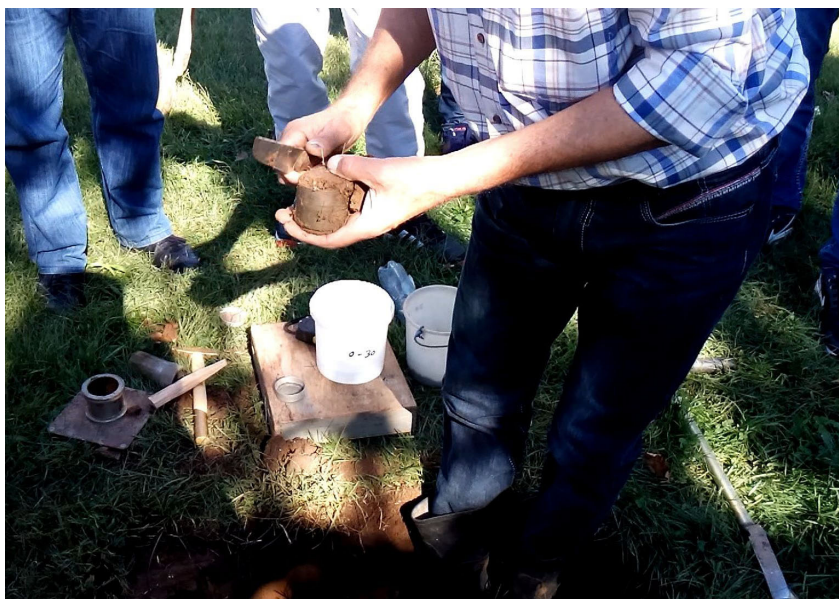
Slika 14. Uzimanje uzoraka pomoću cilindra po Kopeckom (Bojanić Rašović)
