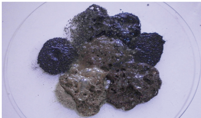
Slika 4. Izdvajanje mjehurića \text{CO}_2 nakon tretiranja uzorka zemljišta 10 % rastvorom \text{HCl} (Bojanić Rašović)
