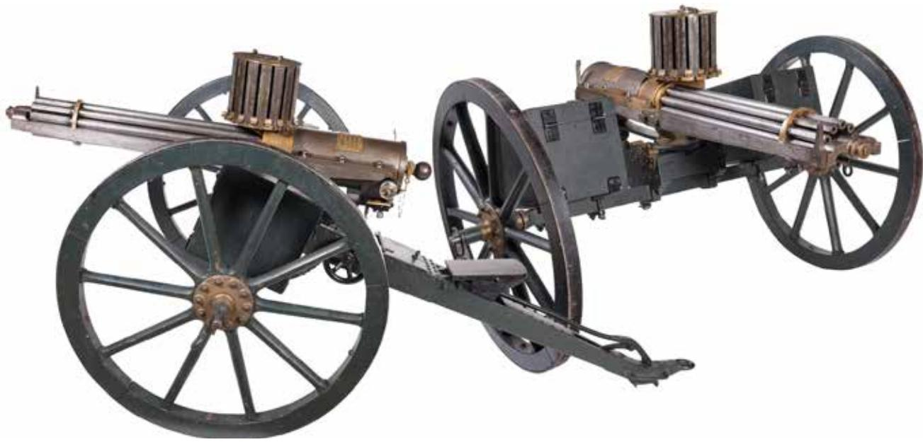
Desetocjevni mehanički mitraljez .45 sistema M1870, proizvodnja W G Armstrong Mitchell & Co.
