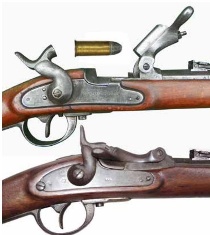
Detalj zatvarača sistema *Wänzl M1866*.
