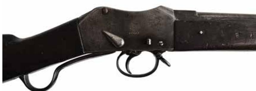
Detalj sanduka sa zatvaračem sistema Peabody-Martini M1871/74.
