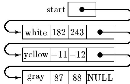
Lako se utvrđuje da veličine pojedinih komponenti strukture iznose redom: 10 (niska), 4 (int), 4 (int) i 4 (pokazivač). Ukupno, jedna promjenljiva tipa `tiptacka` troši 24 bytes (predvodilac je dodao dva bajta).
