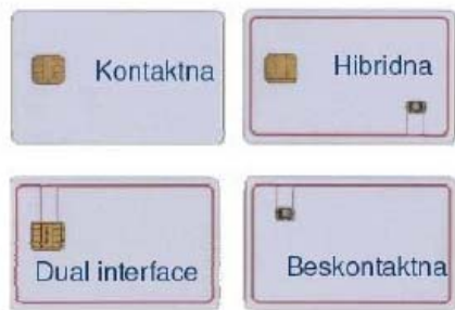
Slika 4.2.2 Interfejsi za razmjenu podataka sa okruženjem kod pametnih kartica
