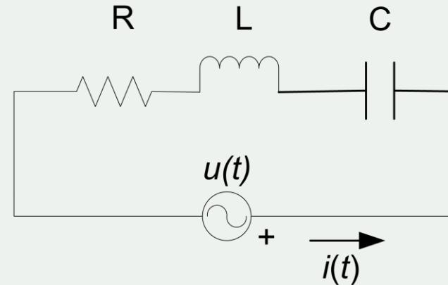
$$\begin{bmatrix} \dot{x}_1 \\ \dot{x}_2 \end{bmatrix} = \begin{bmatrix} 0 & 1 \\ -\frac{1}{LC} & -\frac{R}{L} \end{bmatrix} \begin{bmatrix} x_1 \\ x_2 \end{bmatrix} + \begin{bmatrix} 0 \\ \frac{1}{L} \end{bmatrix} [u]$$
