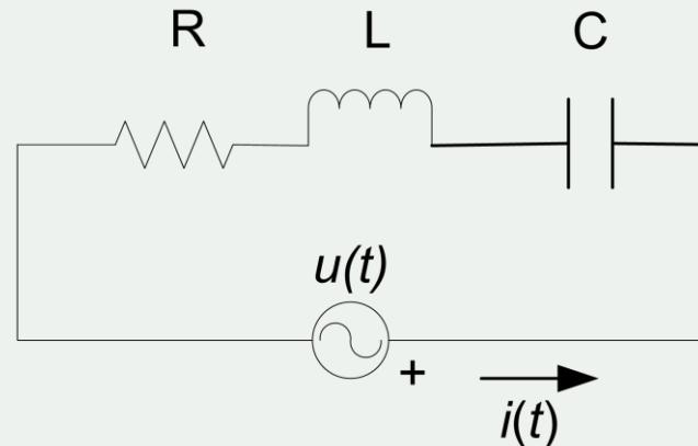
$$\begin{bmatrix} \dot{i}_L \\ \dot{u}_c \end{bmatrix} = \begin{bmatrix} -\frac{R}{L} & -\frac{1}{L} \\ \frac{1}{C} & 0 \end{bmatrix} \begin{bmatrix} i_L \\ u_c \end{bmatrix} + \begin{bmatrix} \frac{1}{L} \\ 0 \end{bmatrix} [u]$$
