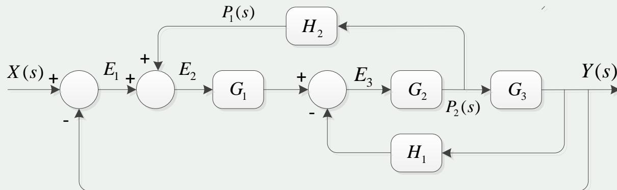
Nekad treba odrediti funkciju prenosa između ulaza i nekog drugog signala u sistemu. To je nalakše odraditi tako što će se signali od interesa zapisati u funkciji od signala greške i ulaznog signala i formirati nove matrice.
