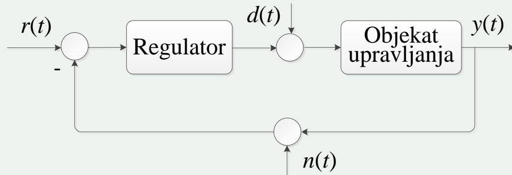
Funkcija prenosa **objekata upravljanja** obuhvata funkcije prenosa procesa, aktuatora i senzora, jer **regulator** koji se dodaje u direktnoj grani „ne vidi“ proces, aktuator i senzor kao odvojene sisteme. Sa  $d(t)$  je označen **aditivni poremećaj** koji djeluje na ulaz aktuatora i procesa. **Šumovi i mjerne nesigurnosti** se modeluju na sa  $n(t)$ . Sa  $r(t)$  je označen **referentni signal**, sa  $u(t)$  **upravljački signal**, a sa  $y(t)$  **regulisana veličina**.
