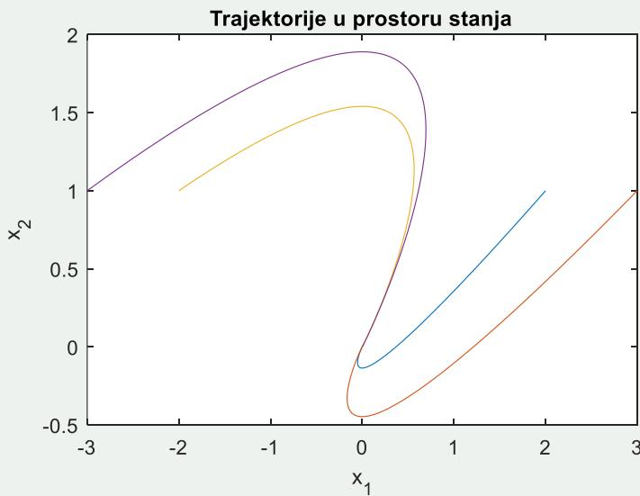
Na slikama iznad su prikazane promjenljive stanja za različite početne uslove. Na slici lijevo su prikazane odgovarajuće trajektorije sistema u prostoru stanju, odnosno zavisnost  $f(x_1, x_2)$ . Na primjer, sistem se kreće iz tačke  $(-3, 1)$  prikazanom putanjom i zaustavlja se u tački  $(0,0)$ . Sa prve dvije slike se uočava da mu je potrebno oko  $7s$  da pređe pomenutu (i svaku ostalu) putanju.
