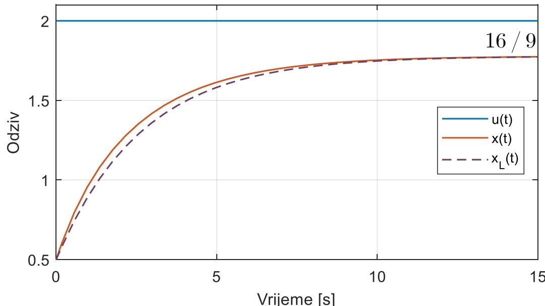
Na slici je prikazana simulaciona šema diferencijalnih jednačina (u Simulink-u). Sa slike lijevo se može uočiti da linearizovani i nelinearni model sistema imaju istu vrijednost odziva u stacionarnom stanju.
